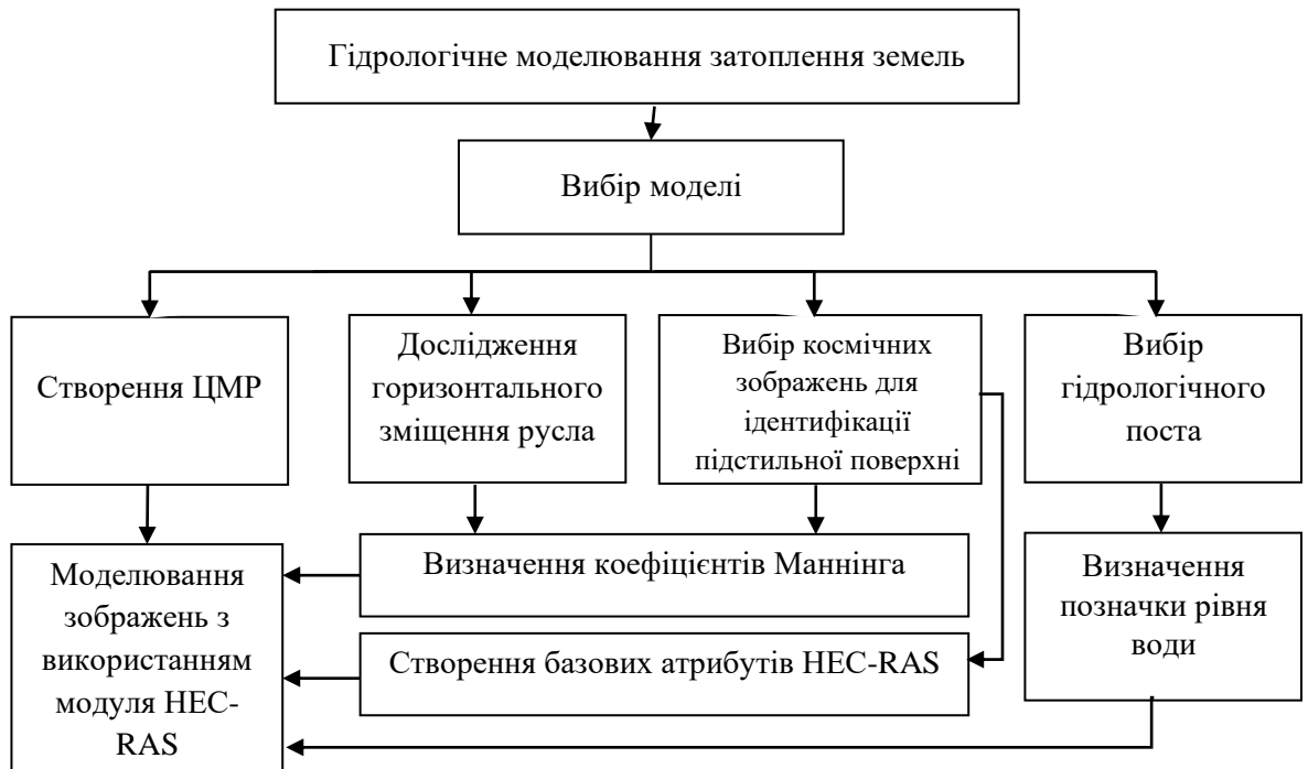
Рисунок 3.15 - Структурна схема гідрологічного моделювання з використанням модуля HEC-RAS
