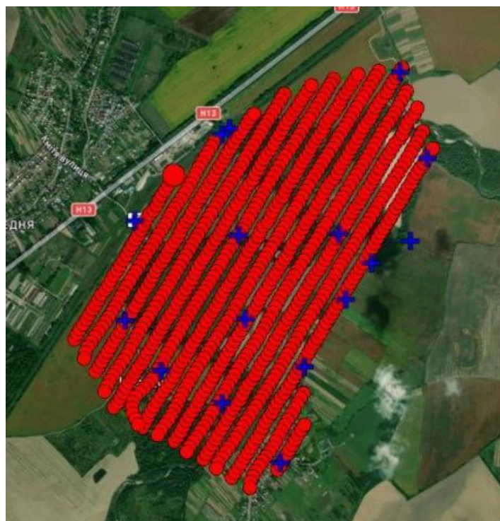
Рисунок 3.33 - Схема розташування центрів проєкцій цифрових знімків та точок геодезичної основи за зніманням 2021 року
