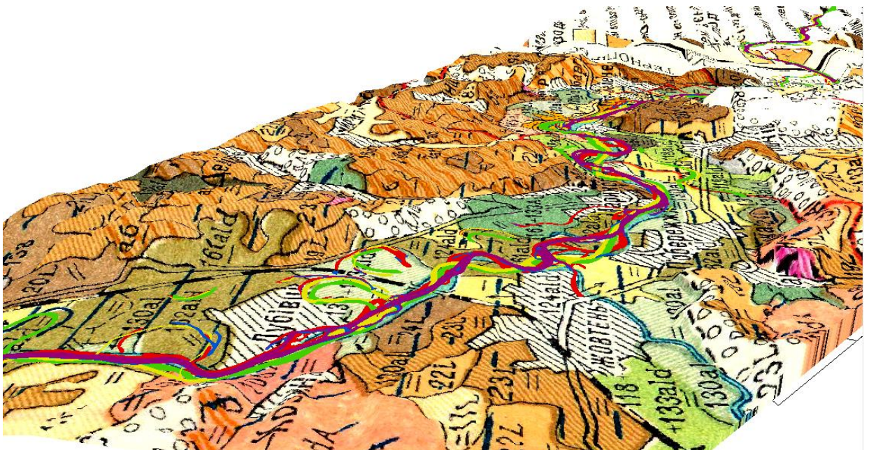
Рисунок 3.11 - ЦМР фрагменту русла з накладеною ґрунтовою картою
