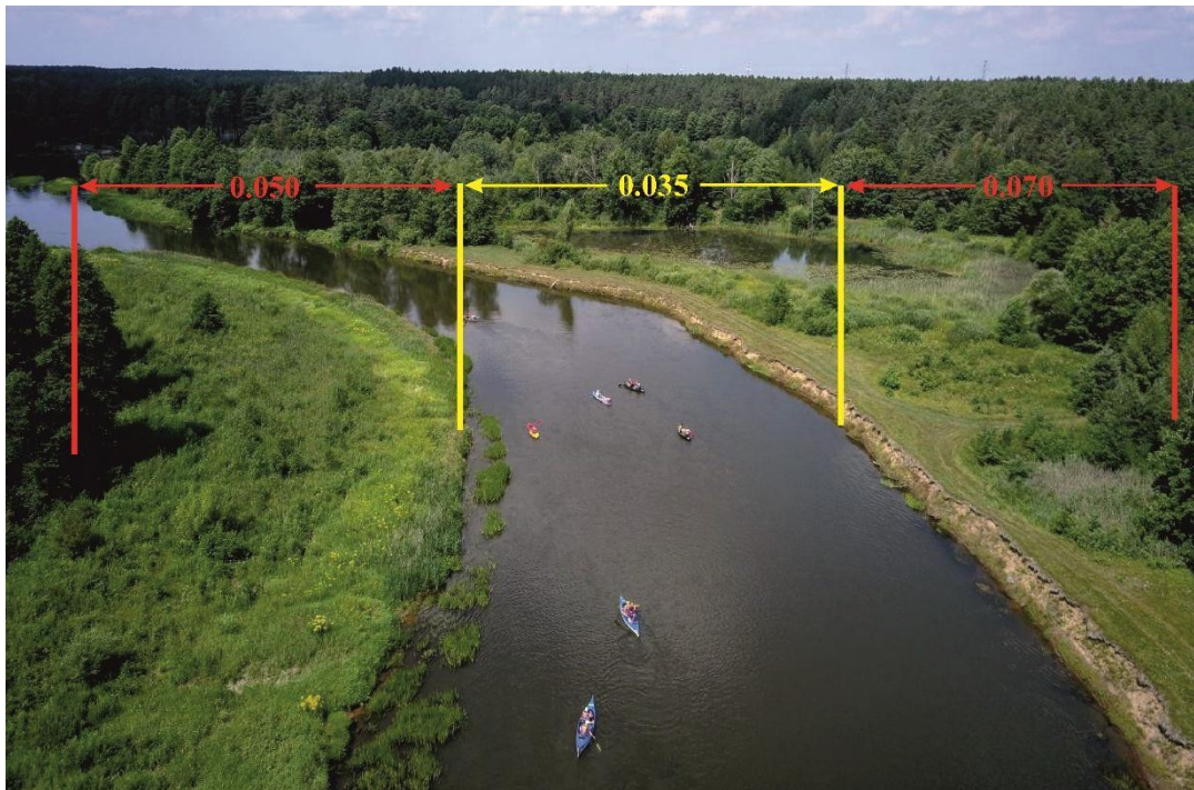
Рисунок 2.2 - Визначені коефіцієнти Маннінга для русла та заплав
