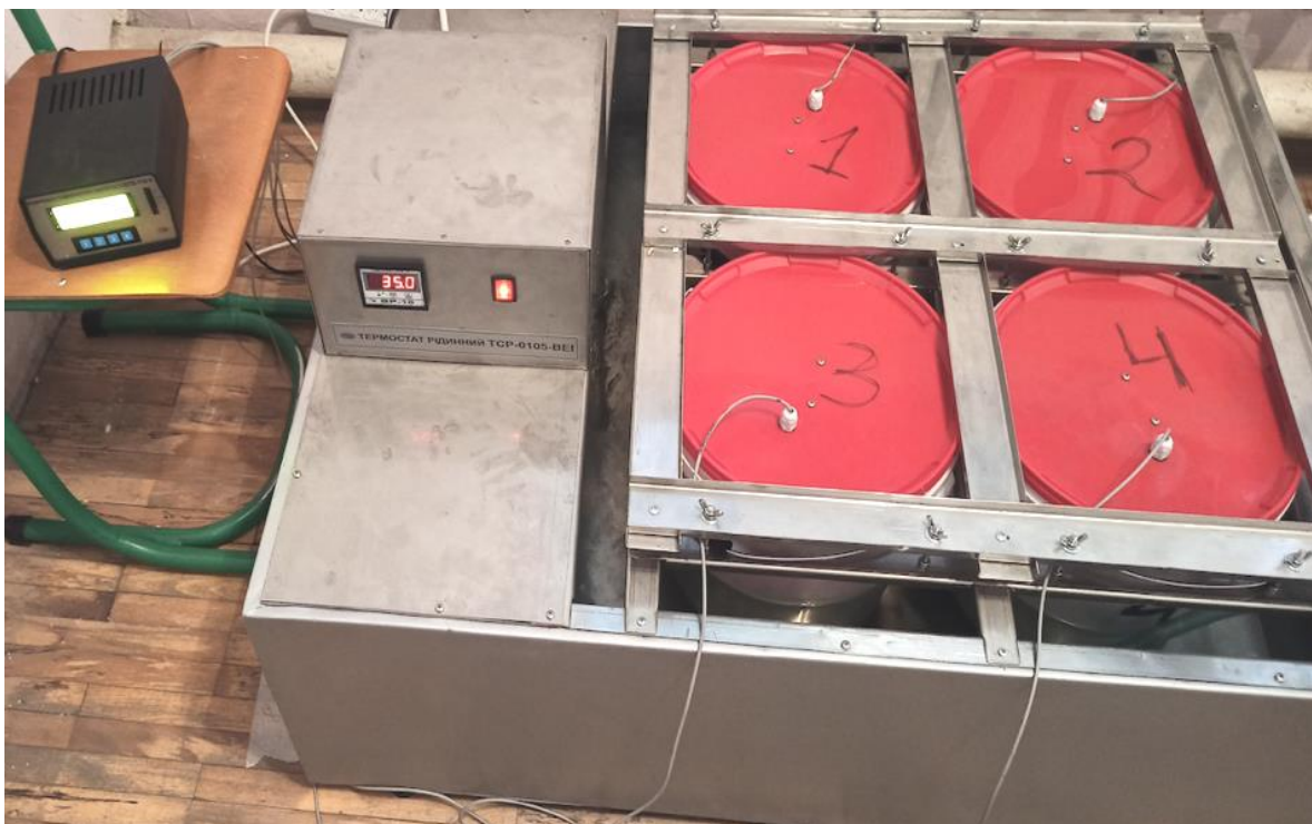
Рис. 2.3. Рамка-кріплення для повного занурення досліджуваних об'єктів в термостат;
