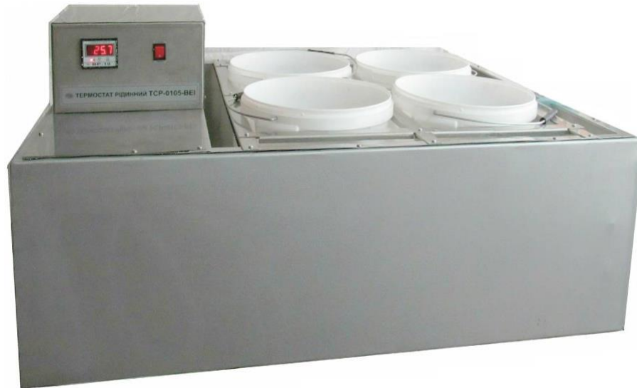
Рис. 2.1. Лабораторна установка для біокомпостування на базі термостату рідинного ТСП-0105
