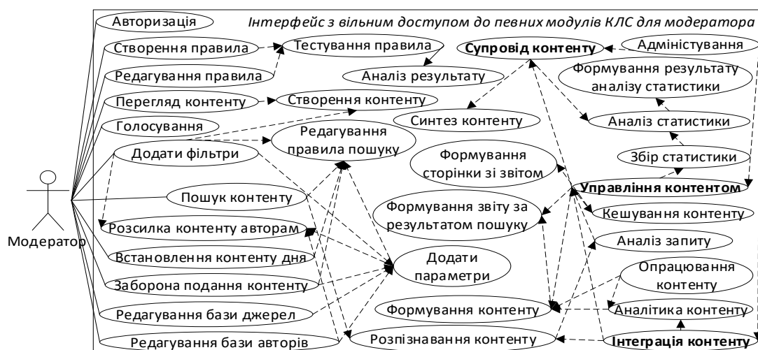
Рис. 2.14. Діаграма use case для доступу модераторів Website КЛС
