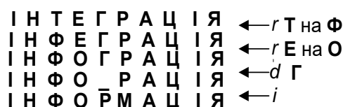
Рис. 5.26. Приклад шляху редагування від одного рядка до іншого
