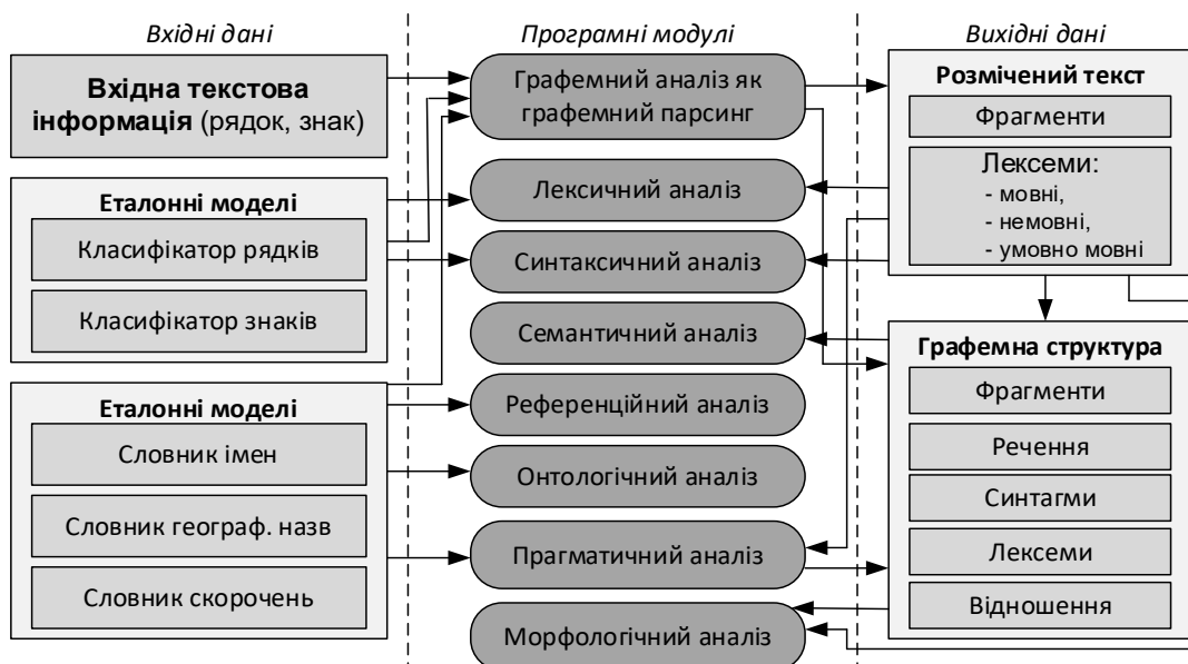
Рис. 3.5. Загальна схема процесу графемного аналізу вхідного тексту
