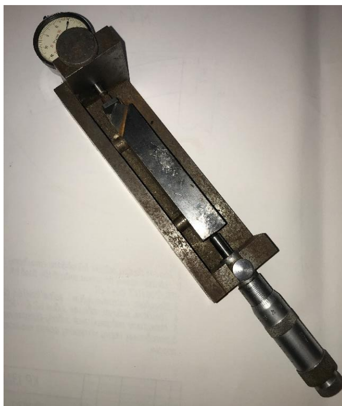
Рис. 4.13. Пристрій для вимірювання розмірного зношування вершини леза різального інструменту. 1- корпус пристрою; 2 - вісь повороту корпусу; 3 - різцетримач; 4 - різець; 5 - індикаторний вимірний пристрій
