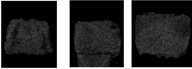
Рис.4.16. Скелетизовані зображення з бази NIST 24 алгоритмом Хілдіча
