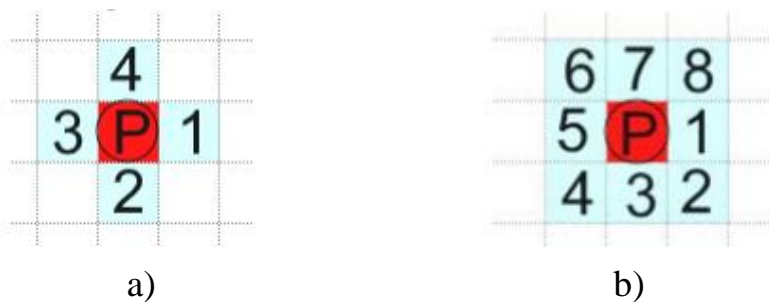
Рис. 3.11. Сусідні пікселі і порядок їх обходу для 4-х зв'язаного (а) і 8-ми зв'язаного (b) представлень
