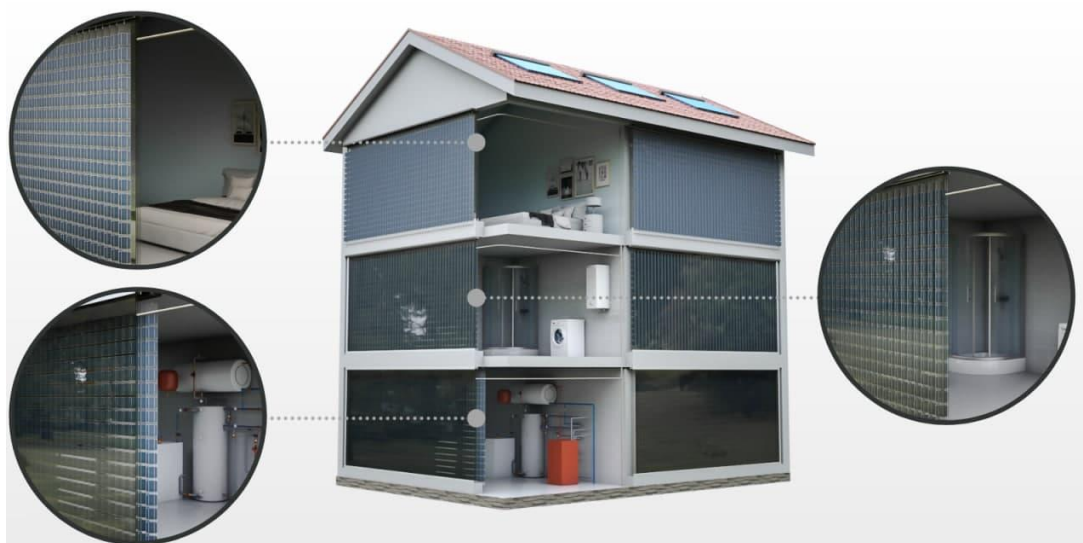
Рисунок 5.7 – Варіювання розташування фотоелементів в конструкції ТФГСК в будівлі із перевищеним коефіцієнтом скління
