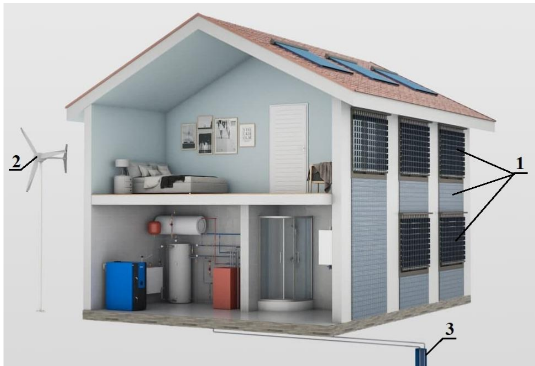
Рисунок 5.9 – ССЕСП, що містить конструкцію ТФГСК та інші альтернативні джерела енергії: 1 –ТФГСК; 2 – вітрогенератор; 3 – ґрунтовий тепловий колектор
