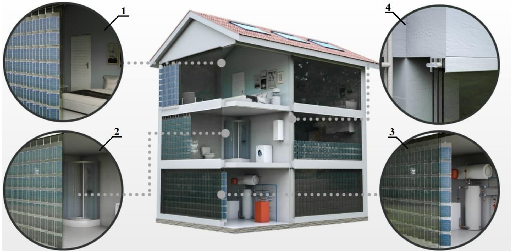
Рисунок 5.4 – ТФГСК елементи якого інтегровані в світлопрозорий фасад будівлі як компонента ССЕРП для інноваційного енергозберігаючого однорідного сімейного будинку: 1 – ролети розташовані перед склом конструкції ТФГСК; 2 – ролети розташовані в конструкції ТФГСК; 3 – ролети розташовані в приміщенні; 4 – ТО ТФГСК
