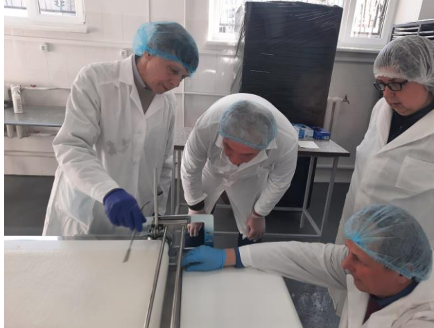
Процес виготовлення гідрогелевих пов'язок у лабораторії Львівської політехніки
