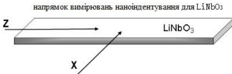
Рис. 2.9. Схема виконання вимірювань нанотвердості
