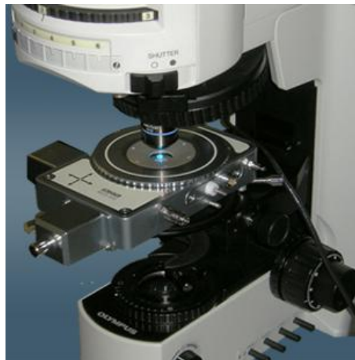
Рис. 2.11. Загальний вигляд спектрометра раманівського розсіювання Mono VistaCRS+
