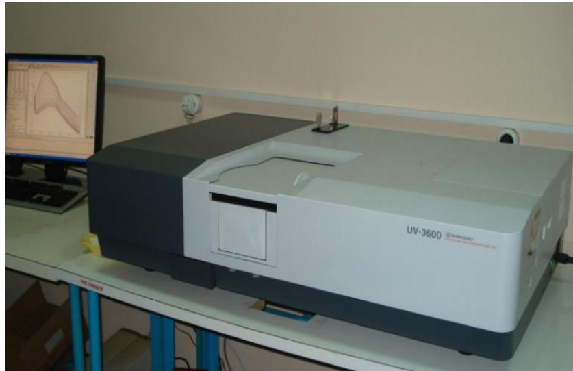
Рис. 2.6. Спектрофотометр Shimadzu UV-3600
