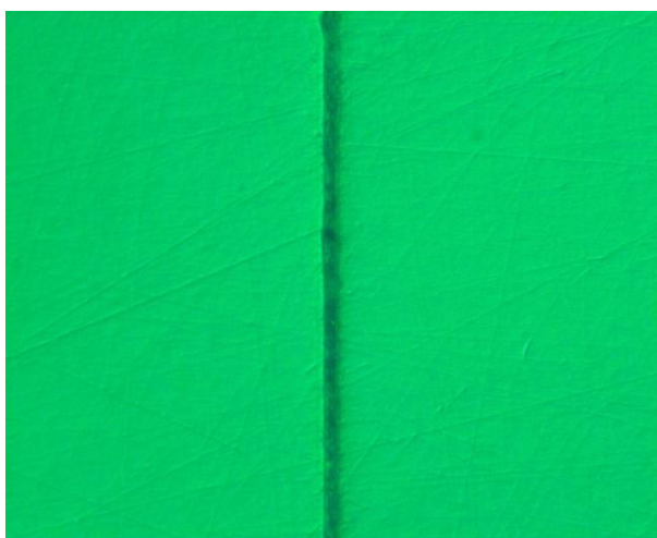
Рисунок 4.3. Фотографія межі з'єднання двох пластин ніобату літію шляхом дифузії міді
