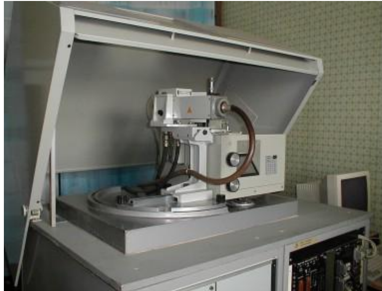
Рис. 2.5. Рентгенівський дифрактометр ДРОН-3М
