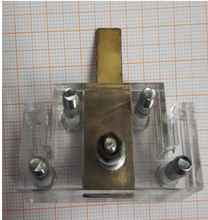
Рис. 4.13. Актюатор точного позиціювання на основі біморфної структури ніобату літію, створеної за допомогою дифузійного з'єднання
