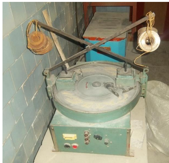
Рисунок 2.9 – Визначення стиранності високоміцного фібробетону на крузі стирання ЛКИ-3
