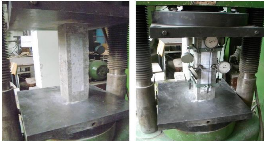
Рисунок 4.25 – Визначення призмової міцності (а) та модуля пружності (б) високоміцного дисперсно-армованого бетону
