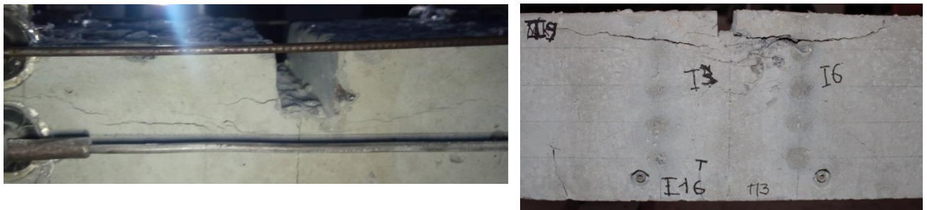
Рис. 3.43. Схематичне відображення утворення та розвитку трапецієвидних тріщин в стиснутому бетоні БП 1.1.2-0-20 серії 1-ї: а) під час виконання експерименту; б) після виконання експерименту виконання
