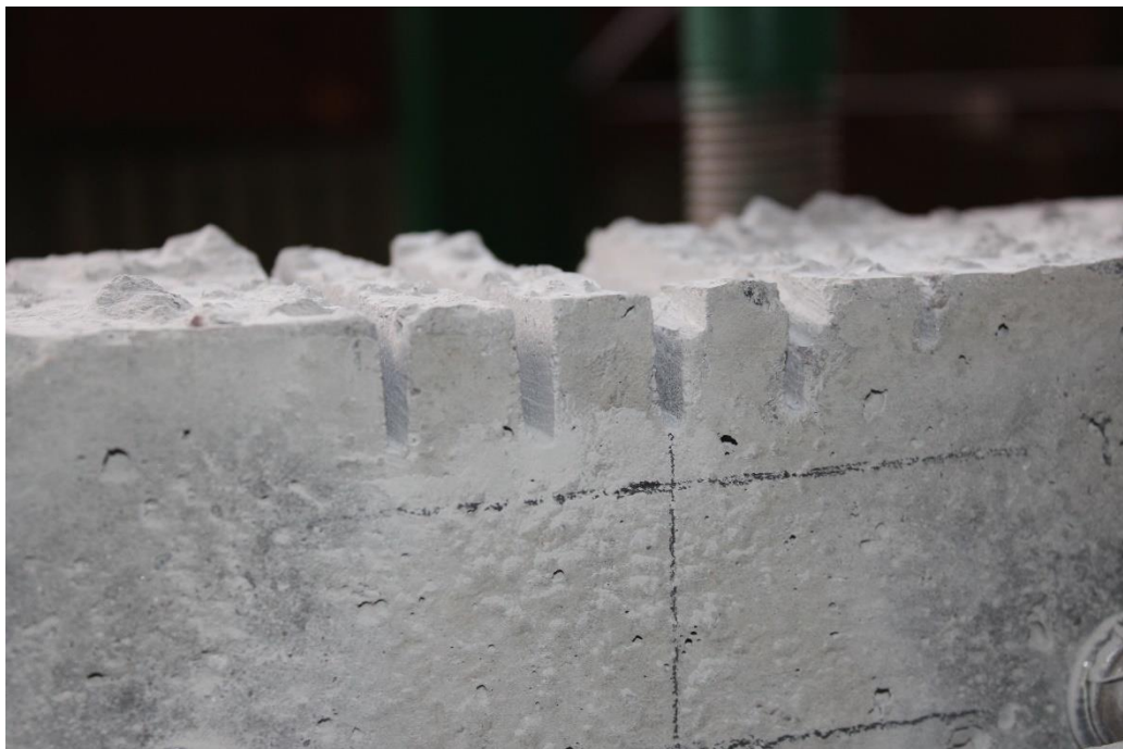
Рис. 2.19. Загальний вигляд виконання проміжних етапів пошкодження за дії навантаження розмірами 80*30мм
