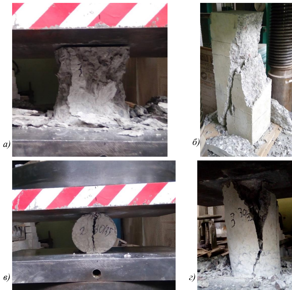
Рис. 2.11. Випробовування бетонних зразків: а) випробувані куби; б) випробувані призми; в) випробувані циліндри на розколювання; г) випробувані циліндри на стиск
