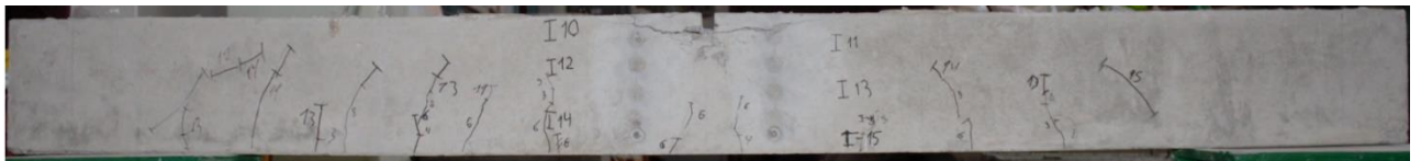
Рис. 3.42. Характер утворення тріщин в центральному перерізі БК 1.1.1-0 серії
