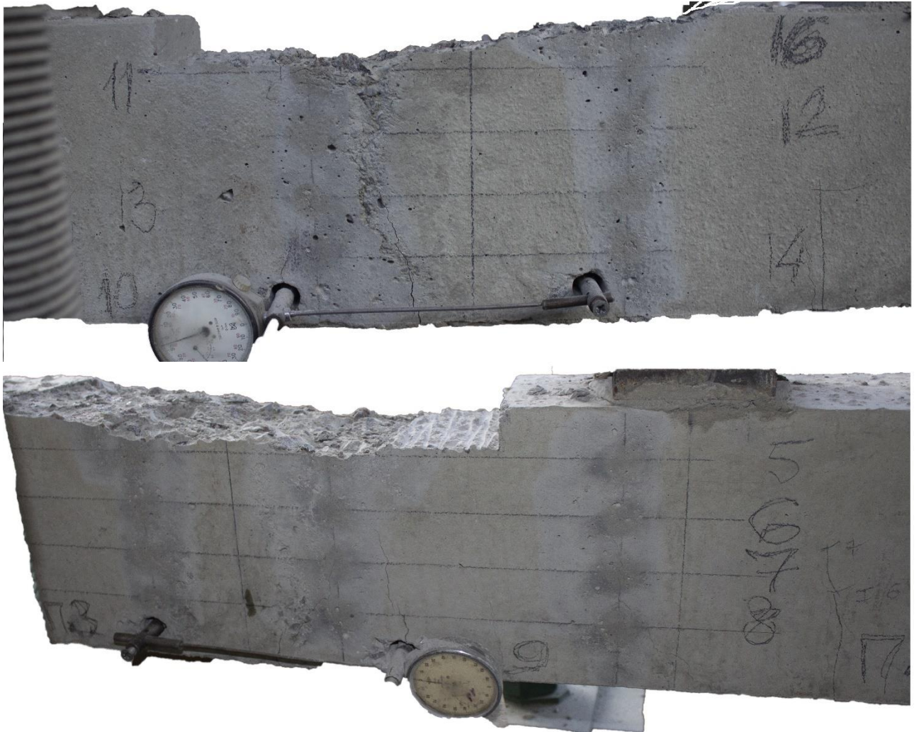
Рис. Б.13. Загальний вигляд утворення тріщин та сколів дослідних зразків БП 2.10.1-0,5-80 зверху та знизу
