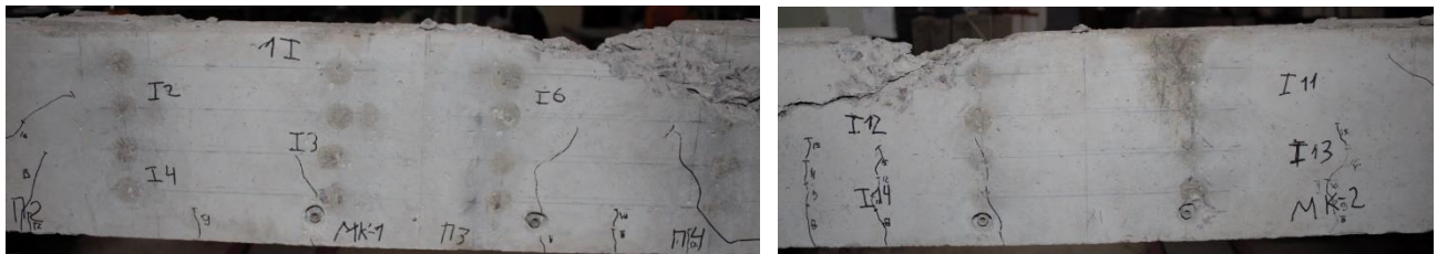
Рис. 3.38. Характер утворення тріщин в центральному перерізі БК 1.1.1-0 серії
