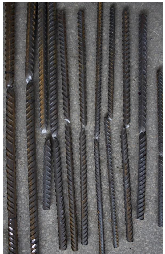
Рис.2.7. Загальний вигляд випробуваних арматурних взірців
