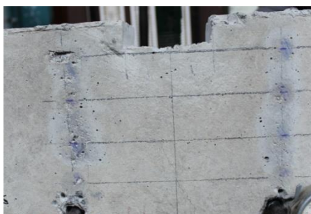
Рис. 3.75. Схематичне відображення утворення та розвитку технічні тріщин в стиснутому бетоні БП 2.6.2-0-80 серії 2-ї: а) під час виконання експерименту; б) після виконання експерименту виконання
