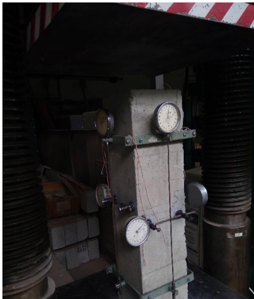
Рис. 2.9. Загальний вигляд випробування бетонної призми
