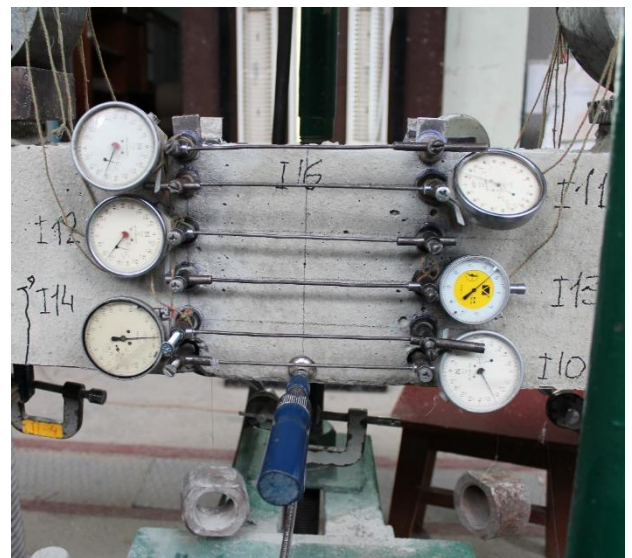
Рис. 2.16. Загальний вигляд розміщення приладів на об'єкті дослідження на зворотній стороні
