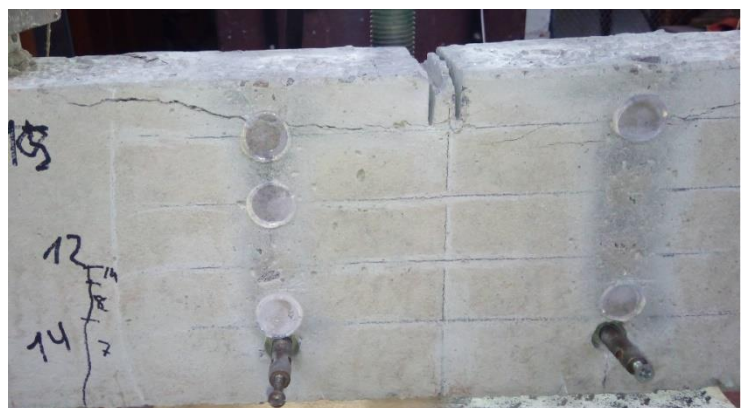
Рис. 3.51. Схематичне відображення утворення та розвитку технічні тріщин в стиснутому бетоні БП 1.3.1-0,5-20 серії 1-ї: а) початок закриття; б) поширення при зростанні навантаження.
