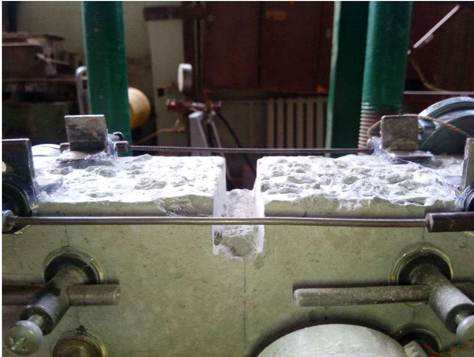
Рис. 2.18. Загальний вигляд пошкодження до дії навантаження розмірами 20*30мм
