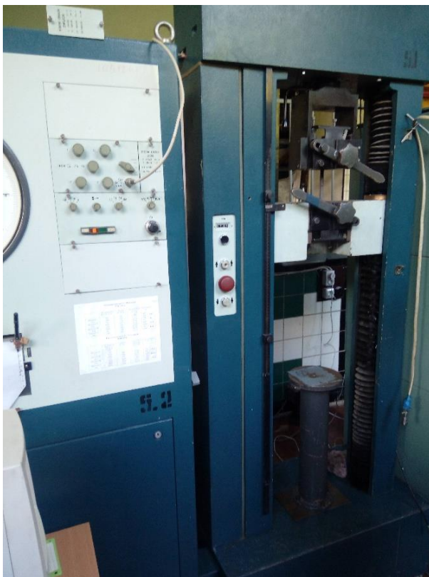
Рис.2.6. Випробування на розривній машині FP 100/1
