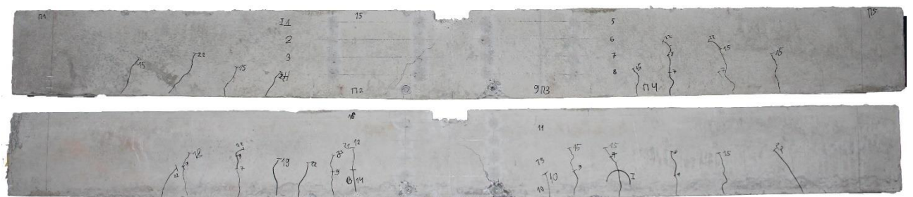
Рис. Б.12. Загальний вигляд утворення тріщин дослідних зразків БП 2.8.2-0,5-80 зверху та знизу
