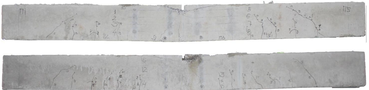
Рис. Б.7. Загальний вигляд утворення тріщин дослідних зразків БК 2.5.1-0 зверху та знизу
