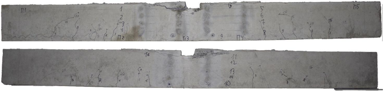
Рис. Б.5. Загальний вигляд утворення тріщин дослідних зразків БП 1.3.2-0,5-80 зверху та знизу
