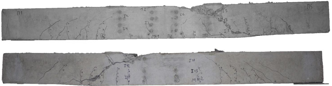
Рис. Б.1. Загальний вигляд утворення тріщин дослідних зразків БК 1.1.1-0 зверху та знизу
