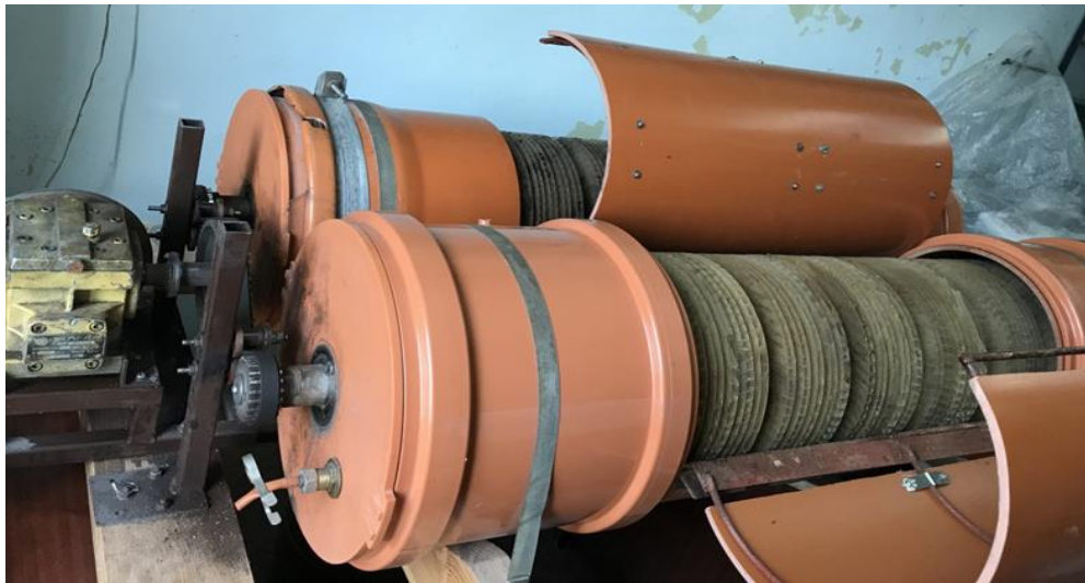
Рисунок 2.4 – Зовнішній вигляд очисної установки з іммобілізованим мікробіоценозом на дисках
