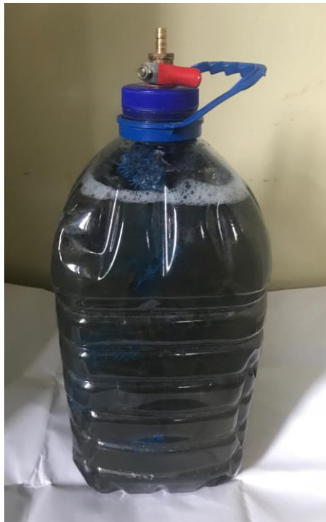
Рисунок 2. 1 – Утворення газоподібних метаболітів іммобілізованою біомасою в аноксидних умовах
