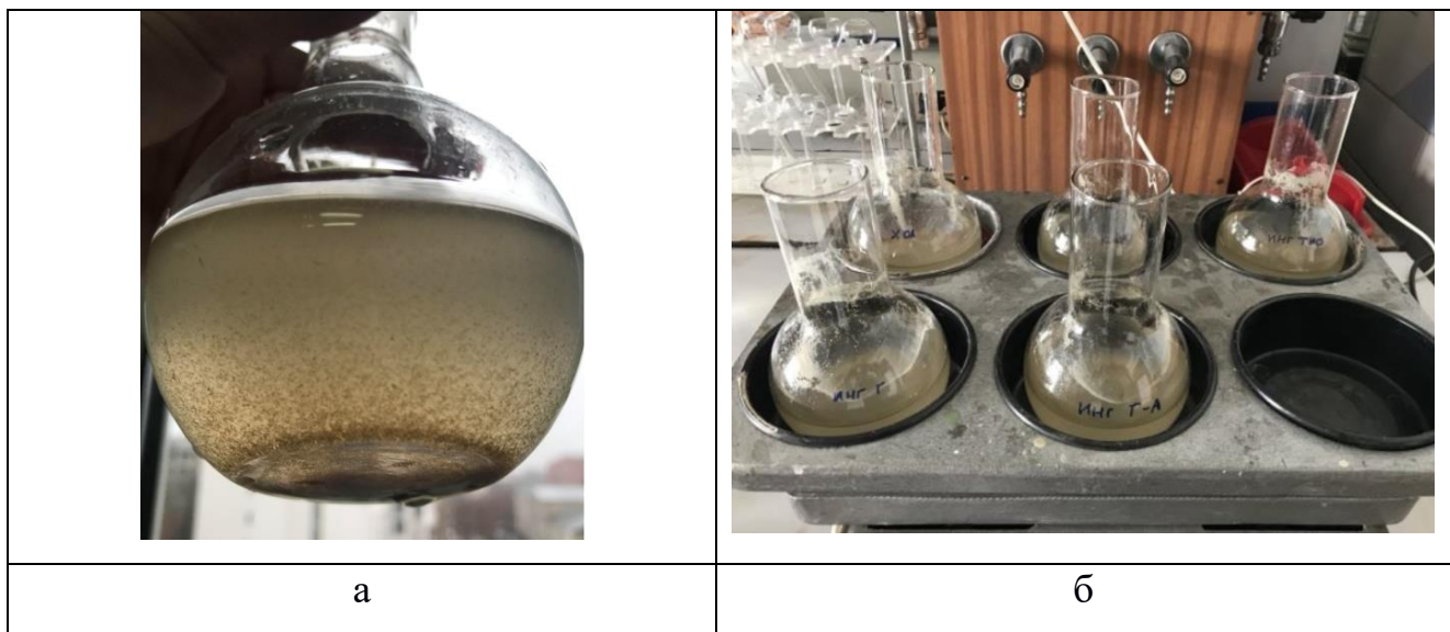
Рисунок 2.3 – Проведення інгібіторного експерименту: а – колба з біомасою в живильному середовищі, б – інкубація п'яти варіантів середовища з біомасою
