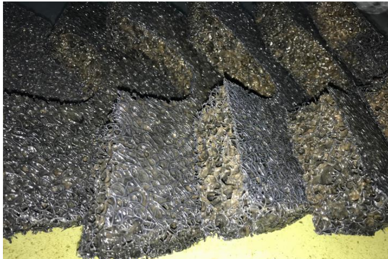
Рисунок 2.8 – Фільтруючий мат – матеріал для виготовлення дисків-біоконтакторів другої зони
