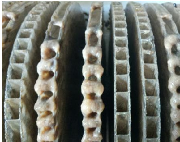
Рисунок 2.7 – Диски стільникового полікарбонату з іммобілізованим мікробіоценозом
