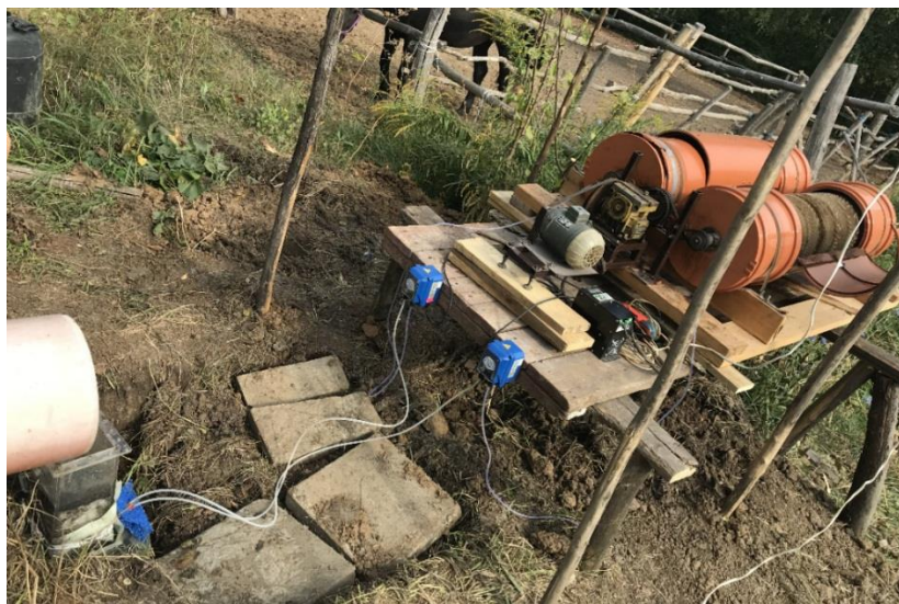
Рисунок 5.8 – Впровадження біодискової установки на території ГО «ФЕЛЬДМАН ЕКО-ПАРК» для очищення стічних вод іммобілізованим біоценозом
