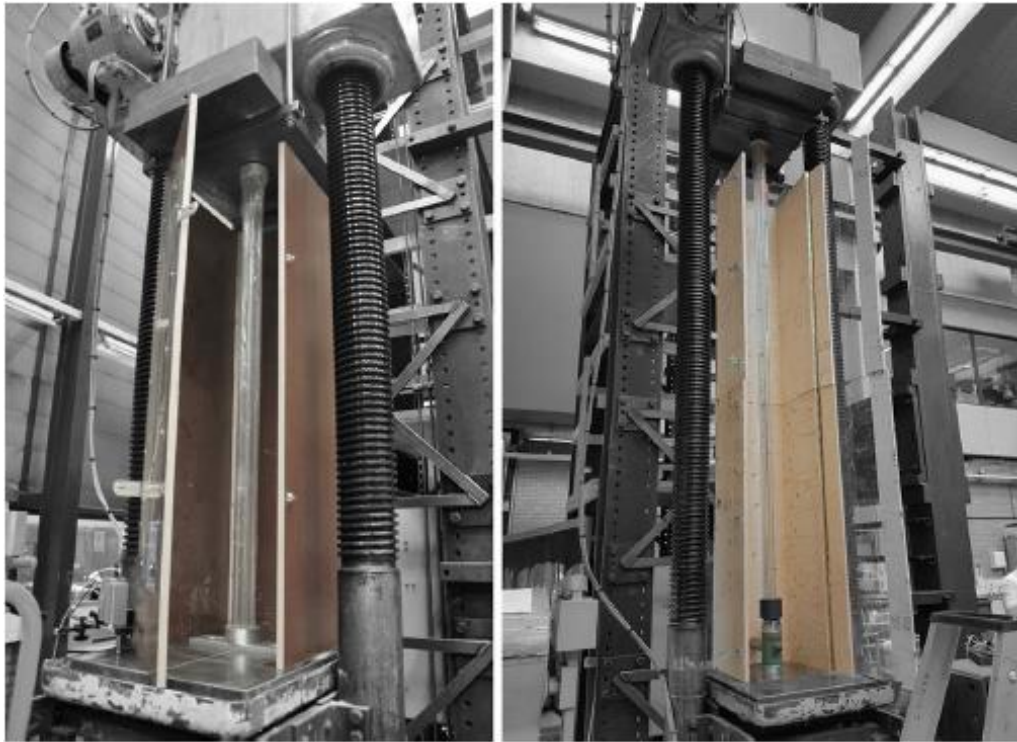
Рис. 1.13 Загальний вигляд пучкових скляних колон при проведенні дослідження з різним закріпленням на кінцях [110 с.13]
