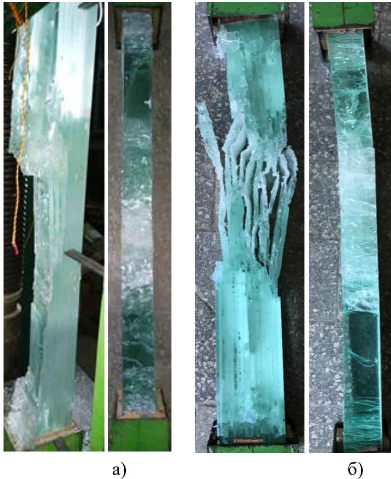
Рис. 3.18. Вигляд дослідних зразків після руйнування та складання їх в проектне положення: а) колона марки КС – 6.1.1; б) колона марки КС – 6.2.1
