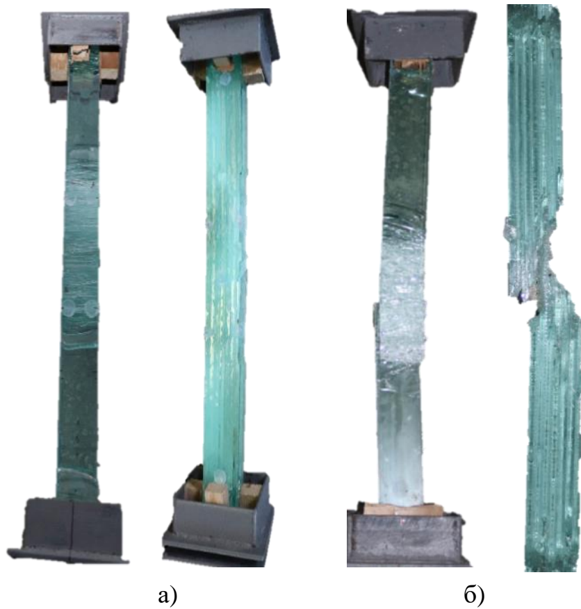
Рис. 3.8. Вигляд дослідних зразків після руйнування та складання їх в проектне положення: а) колона марки КС-3.3.2; б) колона марки КС-3.4.2.
