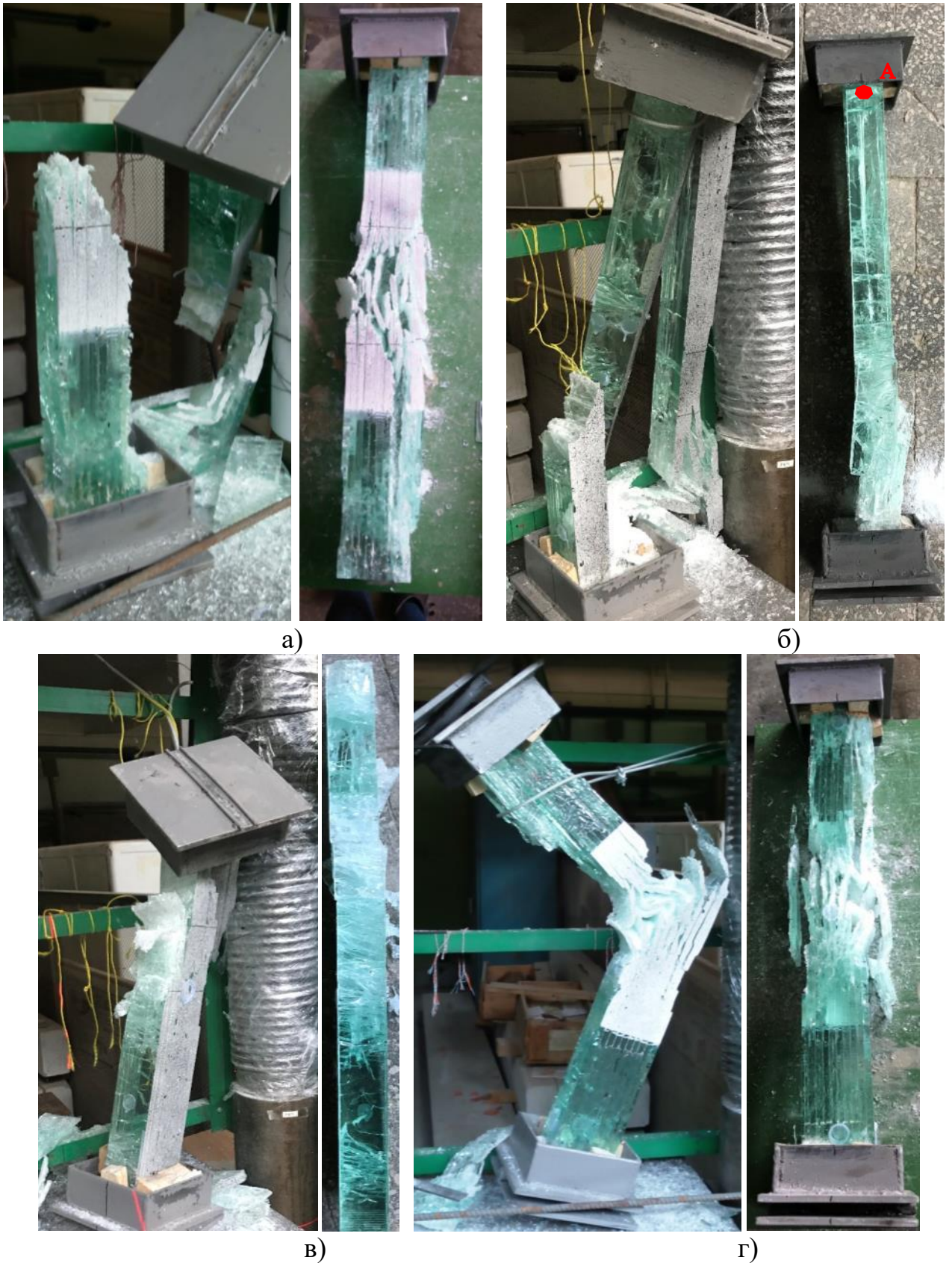
Рис. 3.11. Вигляд дослідних зразків після руйнування та складання їх в проектне положення: а) колона марки КС – 4.1.2; б) колона марки КС – 4.2.2; в) КС-4.3.2; г) КС-4.4.2. т.А-початок руйнування
