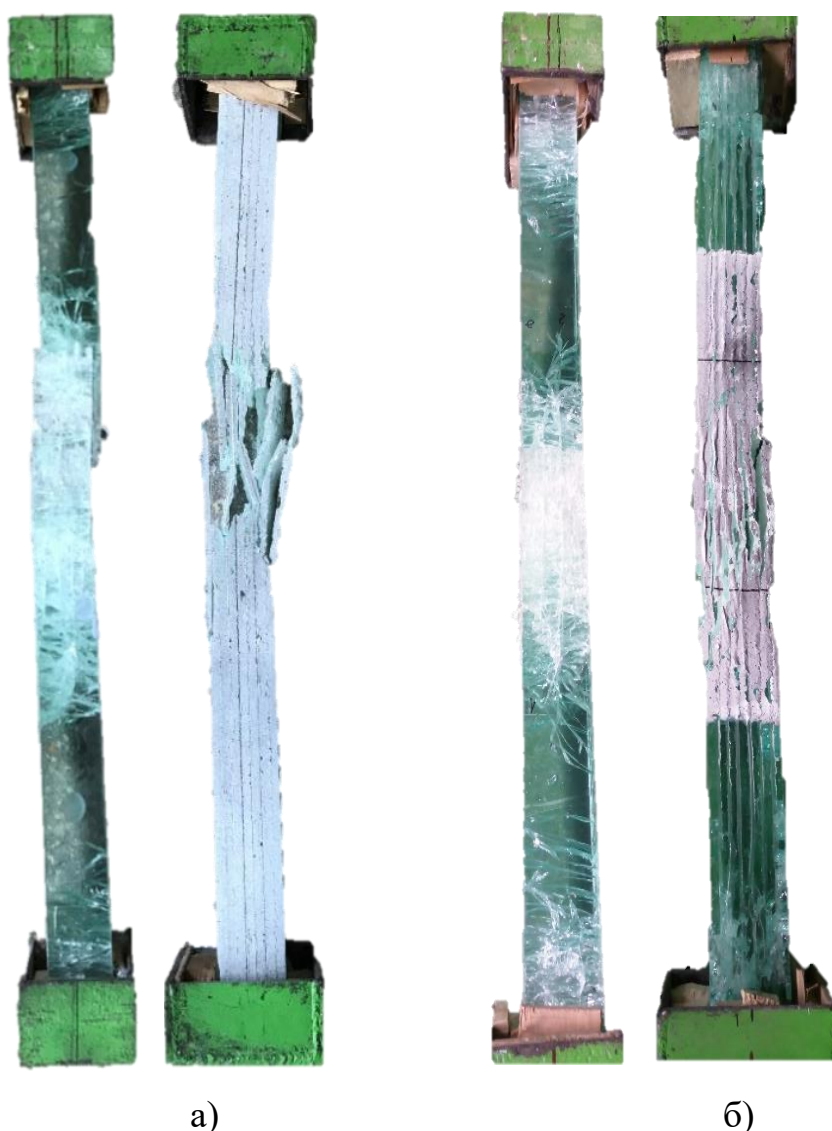
Рис. 3.7. Вигляд дослідних зразків після руйнування та складання їх в проектне положення: а) колона марки КС – 3.1.1; б) колона марки КС – 3.2.1.
