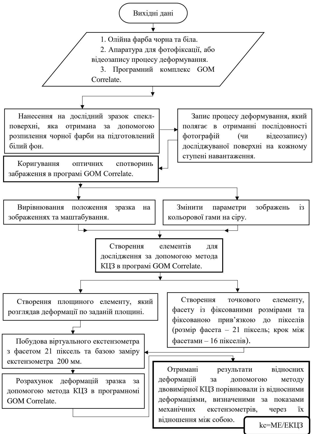
Рис. 2.11. Блок-схема вимірювання поздовжніх деформацій стиснутих скляних колон за допомогою методу двовимірної кореляції цифрових зображень
