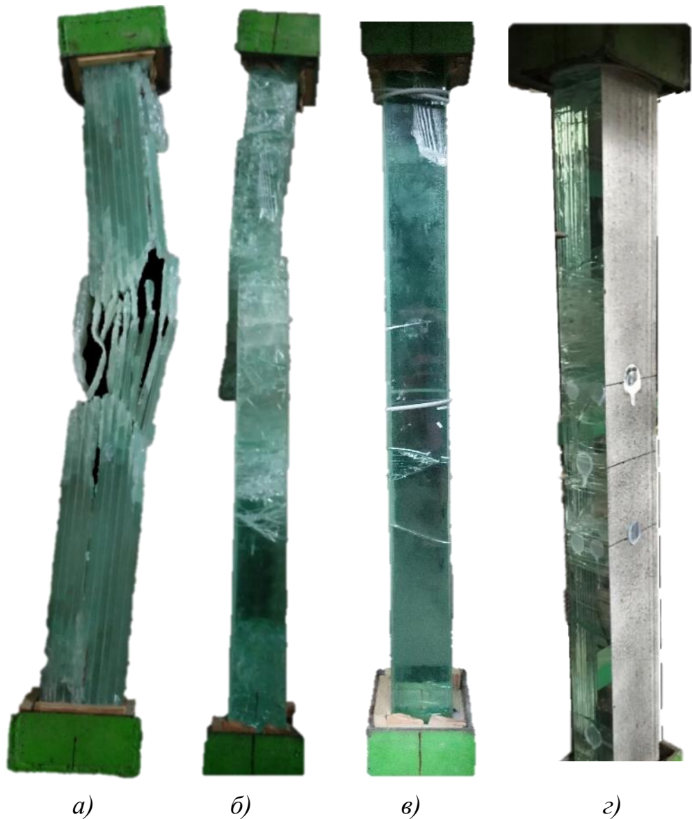
Рис. 3.2. Характер руйнування дослідних зразків I серії а) вигляд з боку колони марки КС – 1.1.1 після випробування; б) фронтальний вид колони марки КС – 1.1.1 після випробування; в) вигляд горизонтальних тріщин колони марки КС – 1.1.1 при N=780 кН; г) вигляд горизонтальних тріщин колони марки КС – 1.2.1 при N = 880 кН.
