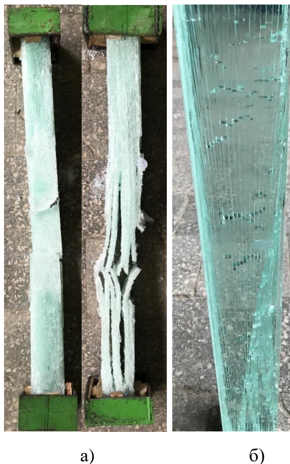
Рис. 3.24. Характер руйнування дослідних колон VIII серії : а) колона марки КС – 8.1.1; б) вигляд вертикальних тріщин колони марки КС – 8.2.1.
