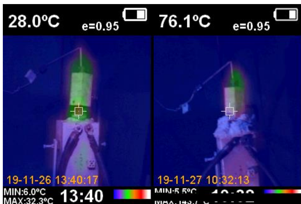
Рис. 8.17. Тепловізорне вимірювання втрат теплоти під час процесу нанесення захисного піровуглецевого покриття на моделі мікротвелу: а, в – під час до додаткової теплоізоляції, г,д – після додаткової теплоізоляції.
