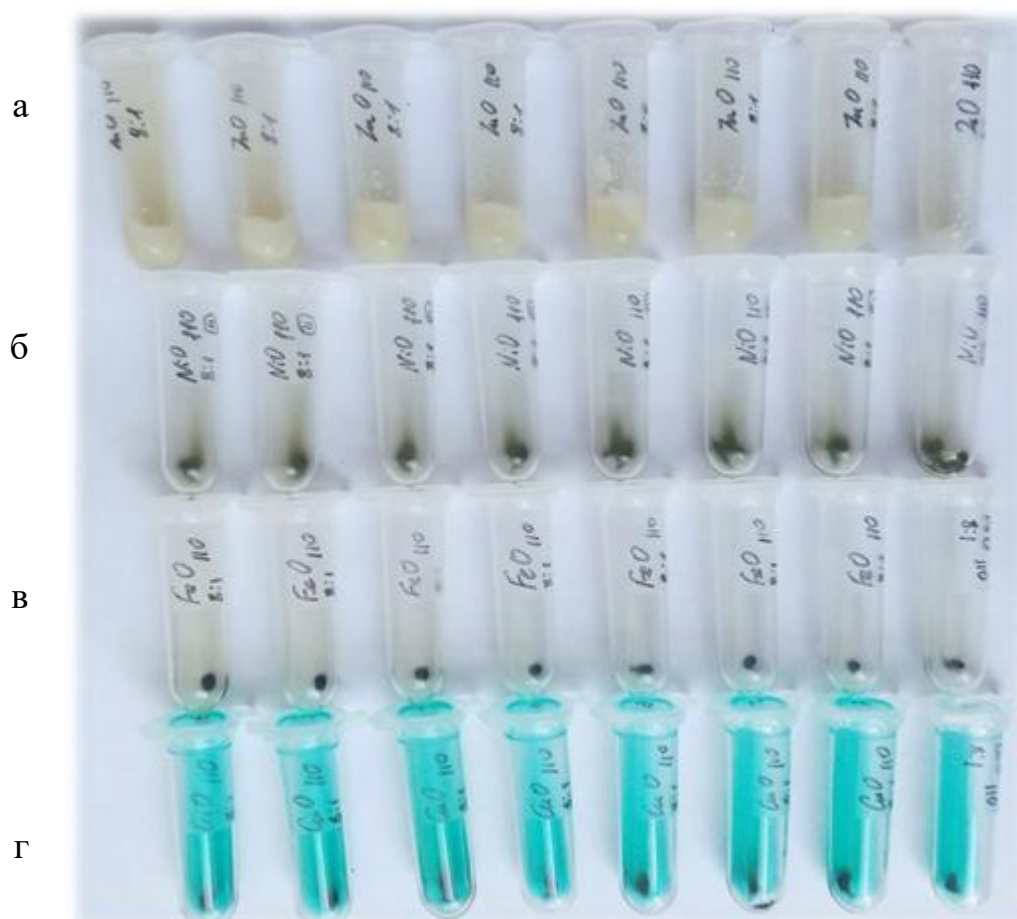
Рисунок 6.3 – Зовнішній вигляд проб реакційної суміші, відібраних при естерифікації олеїнової кислоти бутан-1-олом у присутності: а – ZnO, б – NiO, в – FeO, г – CuO. Температура реакції – 373 К, мольний співвідношення ОК : бутан-1-ол – 1 : 7,6, вміст каталізатора – 0,25 мас. %.
