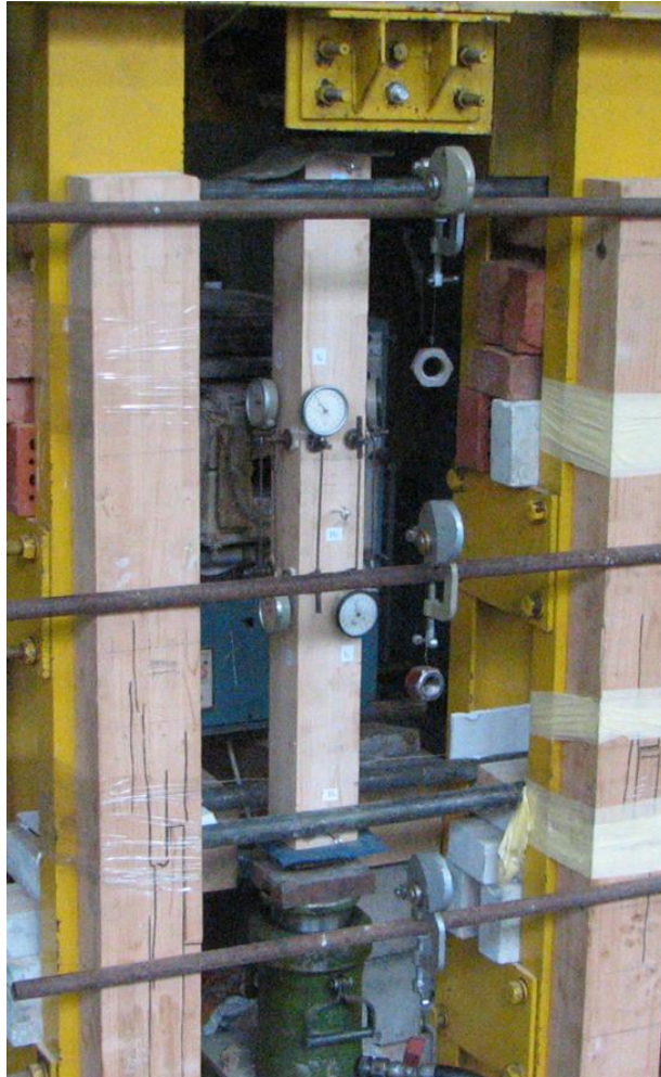
Рис. 2.8. Загальний вигляд стенду для випробувань центрально-стиснутої дощатоклеєної колони при дії локального нагрівання.
