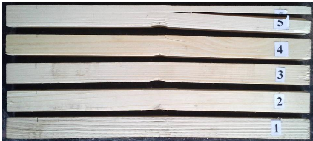
Рис. 3.3. Загальний вигляд зруйнованих зразків на згин;
