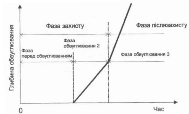
Рис. 1.8. Фази обуглювання захищеної деревини [9].
