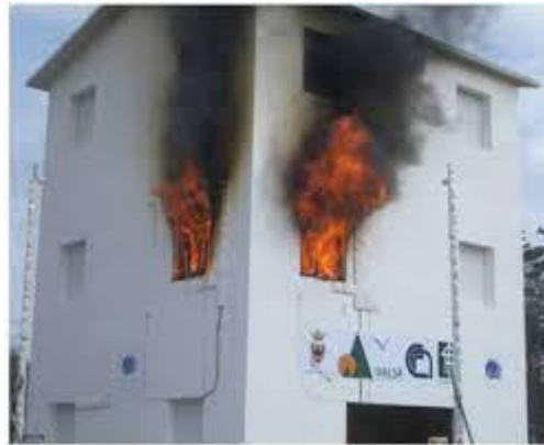
Рис.1.10. Повномасштабне натурне випробування дерев'яної споруди у Японії [48].
