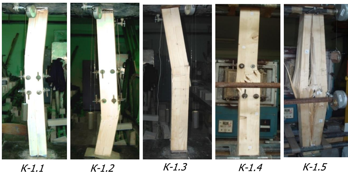
Рис. 3.4. Вигляд стиснутих дощатоклеєних колон після руйнування.
