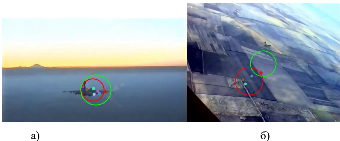
Рис. 2.6. Виникнення помилки I роду в алгоритмі Лукаса-Канаде при наявності сильного кольорового градієнту. а – початковий масив КТ, б – втрата фокусу при маневруванні з пере захопленням КТ фону.
