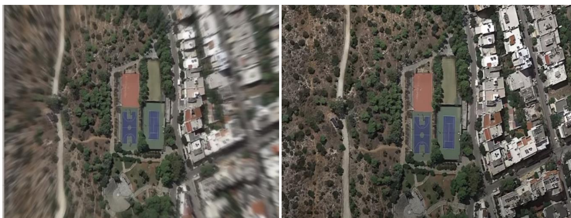
Рис.5.10. Результат адаптивної фільтрації при розмитті периферійної частини кадру
