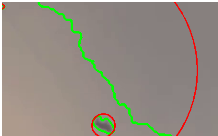
Рис.2.5. Приклад підвищення інформативності зображення за допомогою детектора меж Канні
