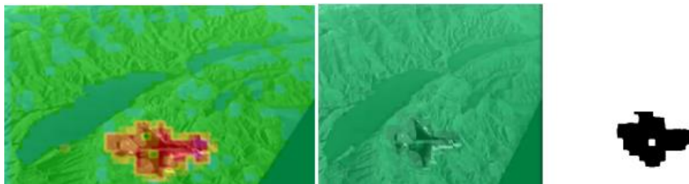
Рис.3.3. Візуалізація процесу виділення рухомих об'єктів за допомогою бінарізації карти швидкостей.
