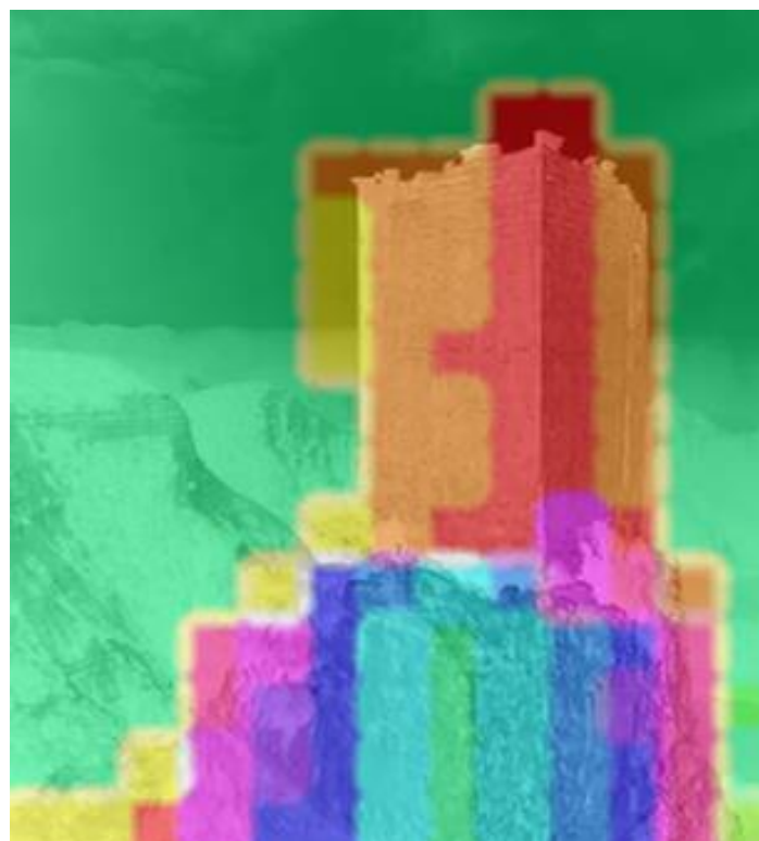
Рис.2.4. Фільтрація карти глибини зображення за допомогою операторів ерозії і ділатації
