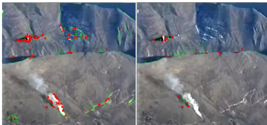
Рис.4.14. Вплив ітераційного числа оператора ерозії на детектори контурів та ключових точок.
