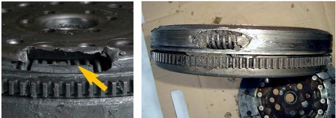
Рис. 2.6. Протирання корпусу ДММ пружинами [107, 109]
