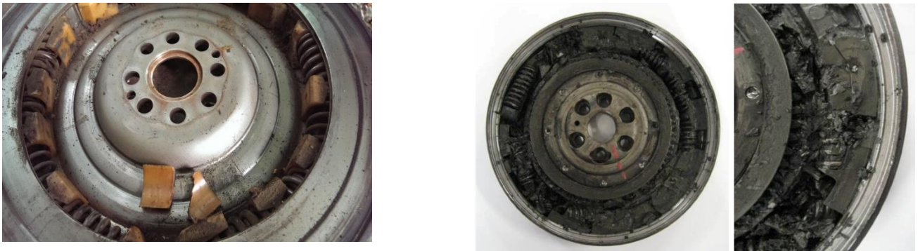
Рис. 2.4. Руйнування сепараторів та пружин всередині ДММ [101, 108]
