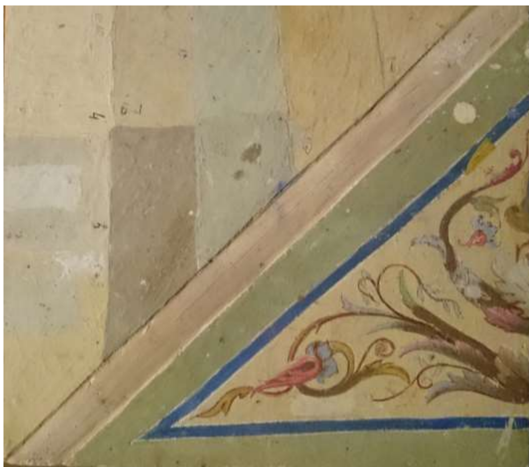
Рис. 11. Випробування на колір і властивості казеїнових і крейдо-клейових фарб та їх сумісність між собою та основою (автор – С. Гетьманчук).
