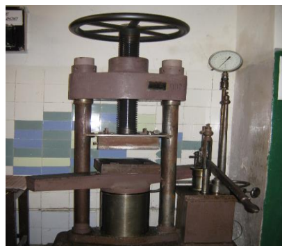
Рис. 2.6 – Вид гідравлічного преса, на якому проводилося формування паливних гранул
