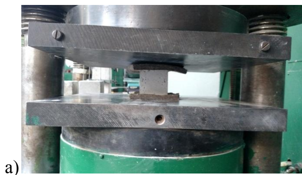
Рис. 2.8. Випробування кубів розчину Ruredil X Mesh M750: а) процес випробування на стиск; б) випробувані зразки однієї серії
