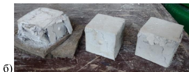
Рис. 2.8. Випробування кубів розчину Ruredil X Mesh M750: а) процес випробування на стиск; б) випробувані зразки однієї серії
