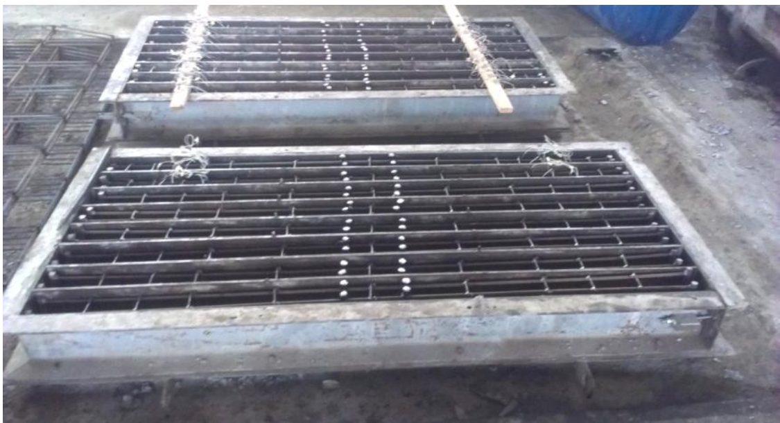
Рис. 2.4. Інвентарна форма з змонтованими каркасами балок
