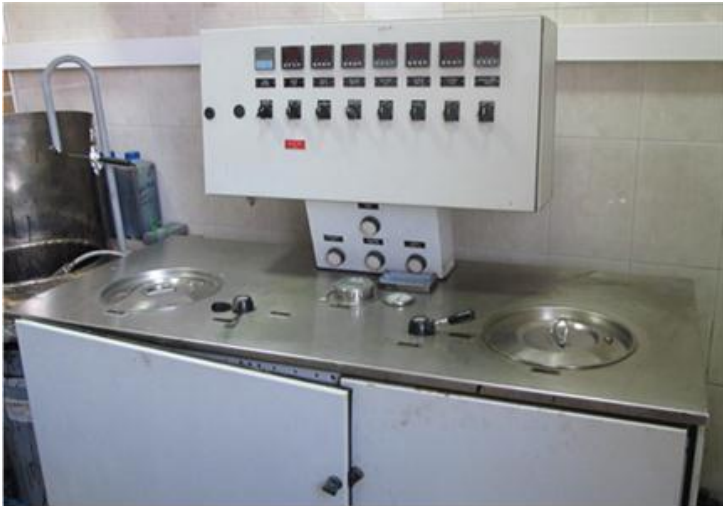
Рис. 3. Лабораторна бітумно-емульсійна установка SEP-0,3R
