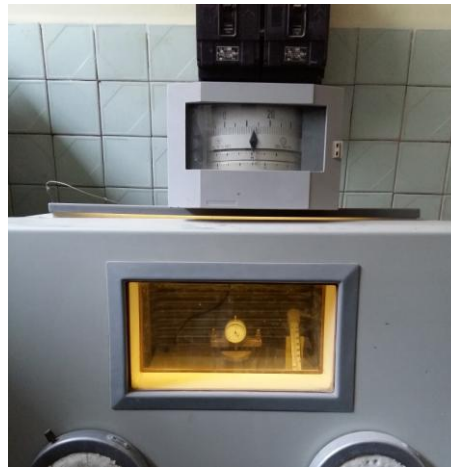
Рис. 2.9. Камера для визначення низькотемпературної дилатометрії
