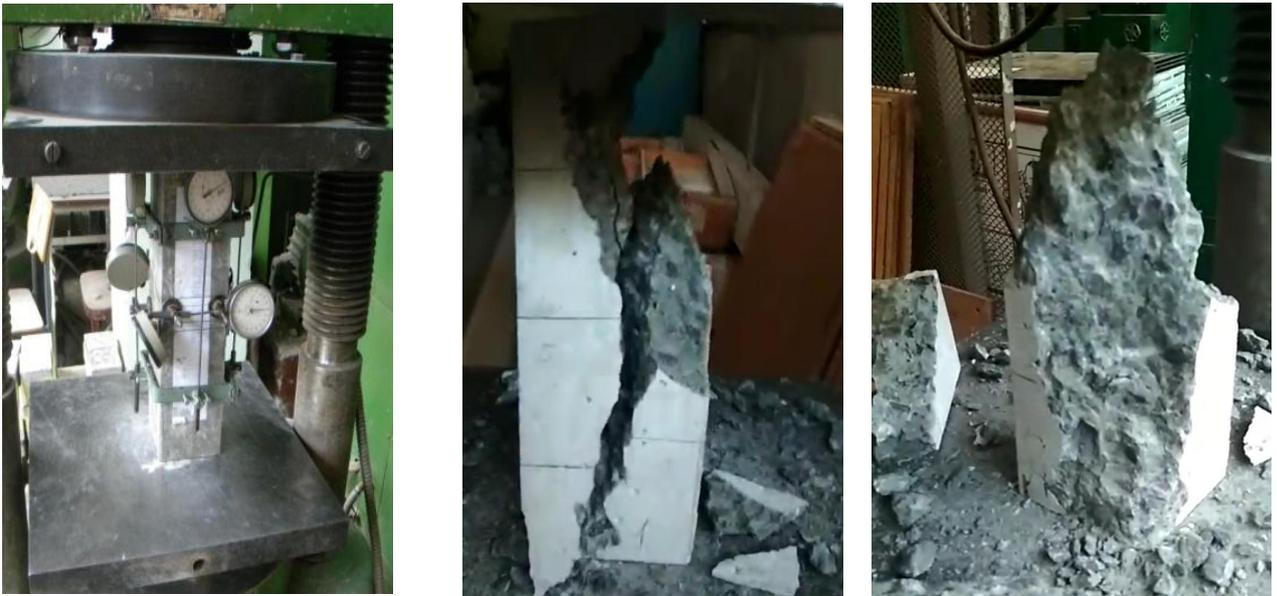
Рис. 4.14. Визначення модуля пружності та призової міцності модифікованого бетону
