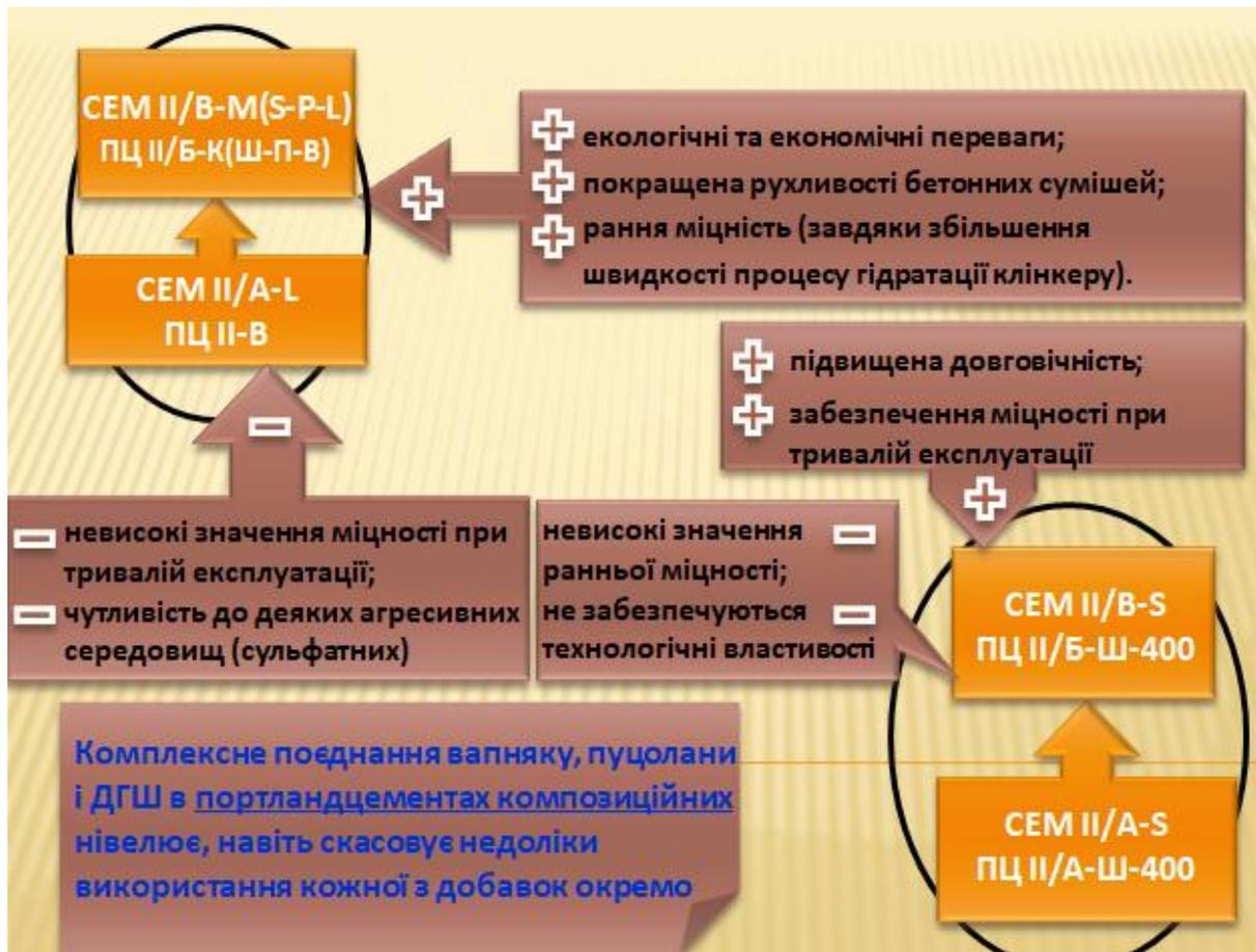
Рис. 3.11. Блок-схема поєднання основних властивостей композиційних портландцементів типу II
