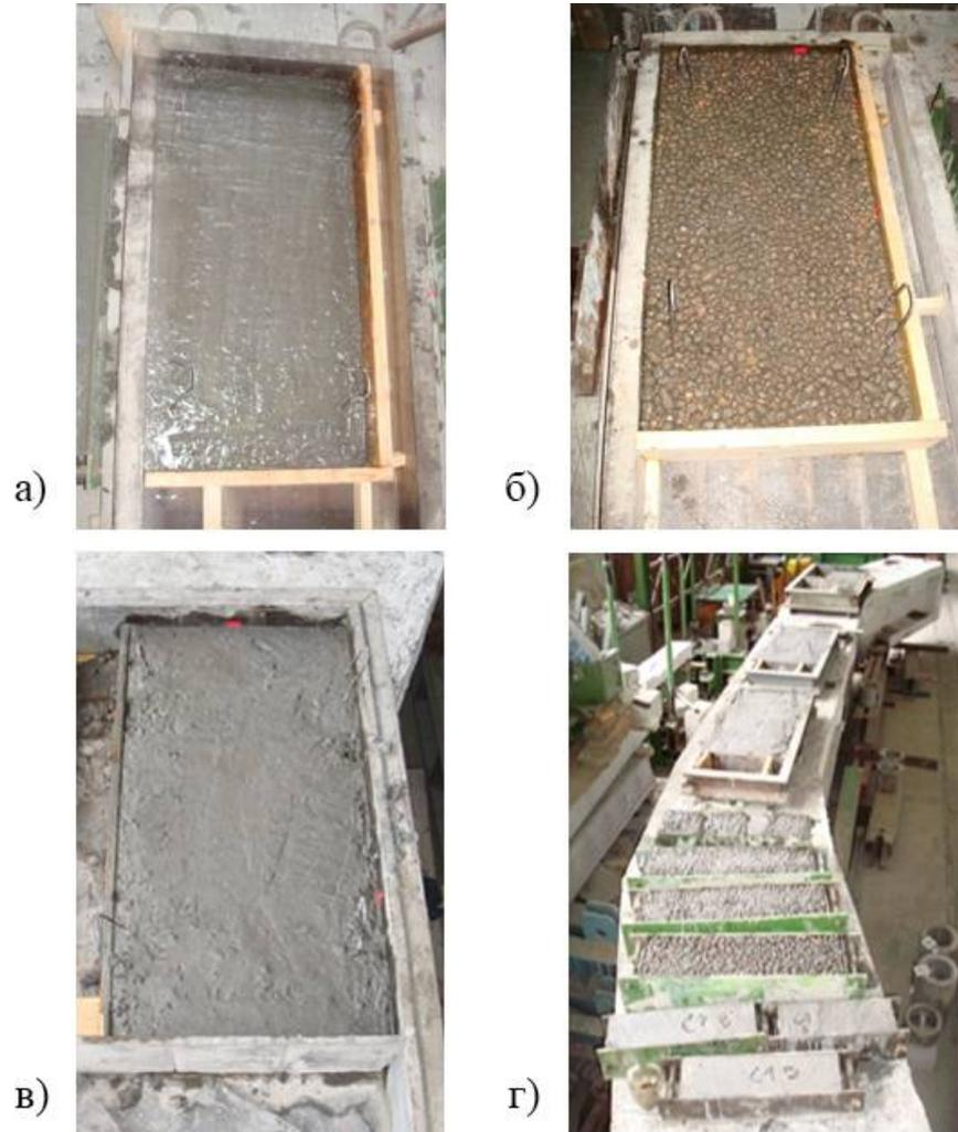
Рис. 2.4 Бетонування багатошарових плит: а) укладка нижнього шару із важкого бетону в плиті марки БП-1.1; б) укладка середнього шару із керамзитобетону в плиті марки БП-1.1; в) укладка верхнього шару із важкого бетону в плиті марки БП-1.1; г) формування кубів та призм
