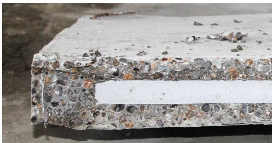
Рис. 3.24 Плита П-3.2 у розрізі після випробування
