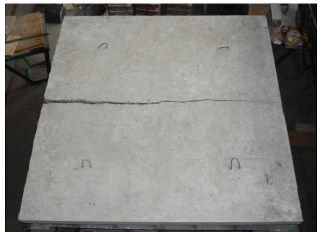
Рис. 3.10 Характер руйнування плит серії 2 марок П-2.1...П-2.6.
