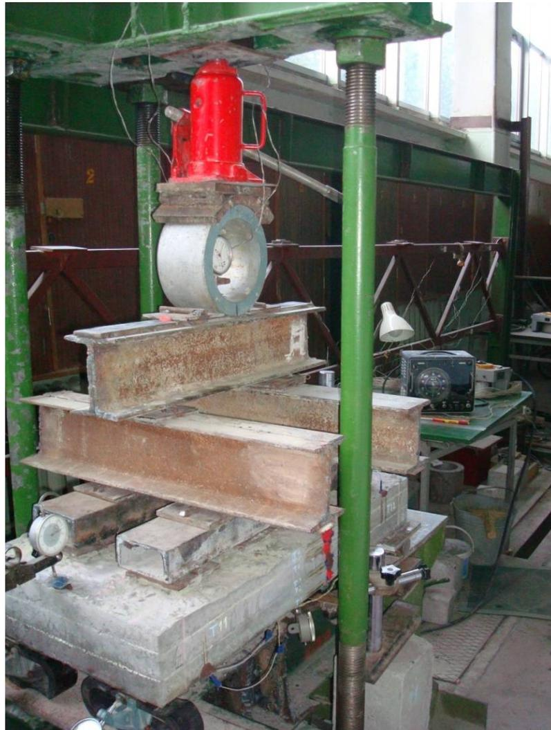
Рис. 2.7 Загальний вигляд стенду для випробування плити серії 1
