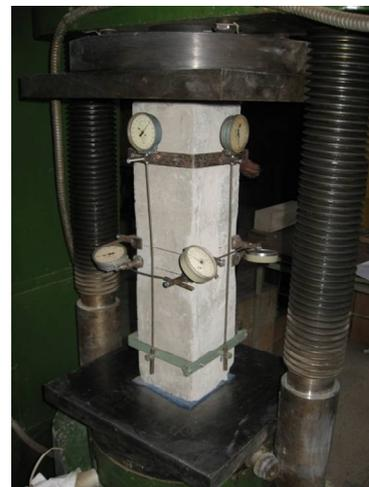
Рис. 2.14 Випробування бетонних призм
