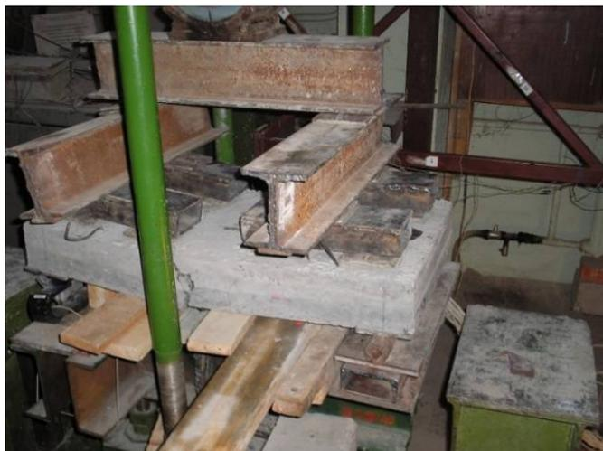
Рис. 3.1 Вигляд дослідної плити БП-1.1 після руйнування
