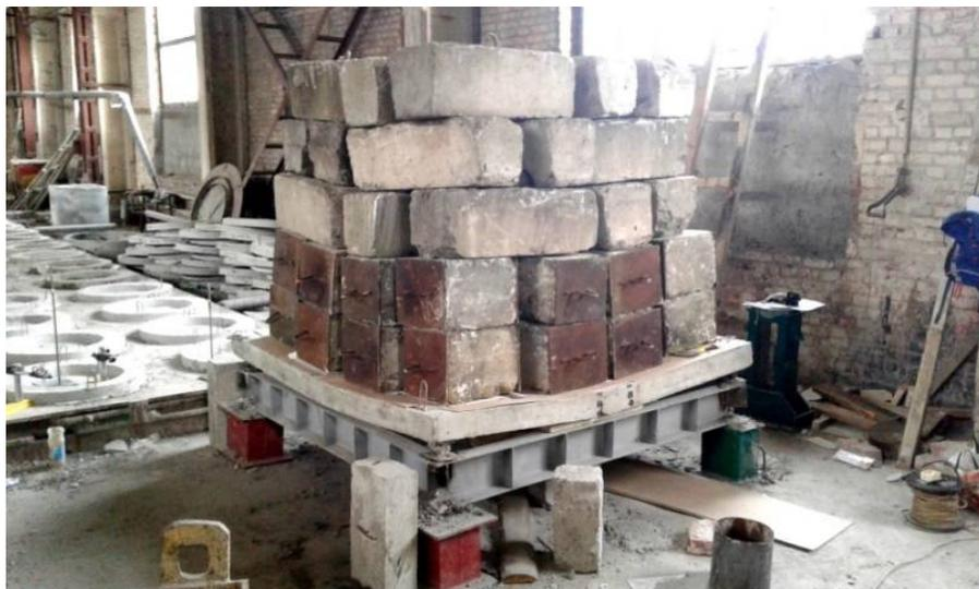
Рис. 3.17 Вигляд дослідної плити П-3.2 після руйнування
