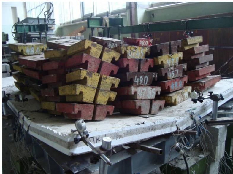
Рис. 3.9 Вигляд дослідної плити П-2.1 після руйнування
