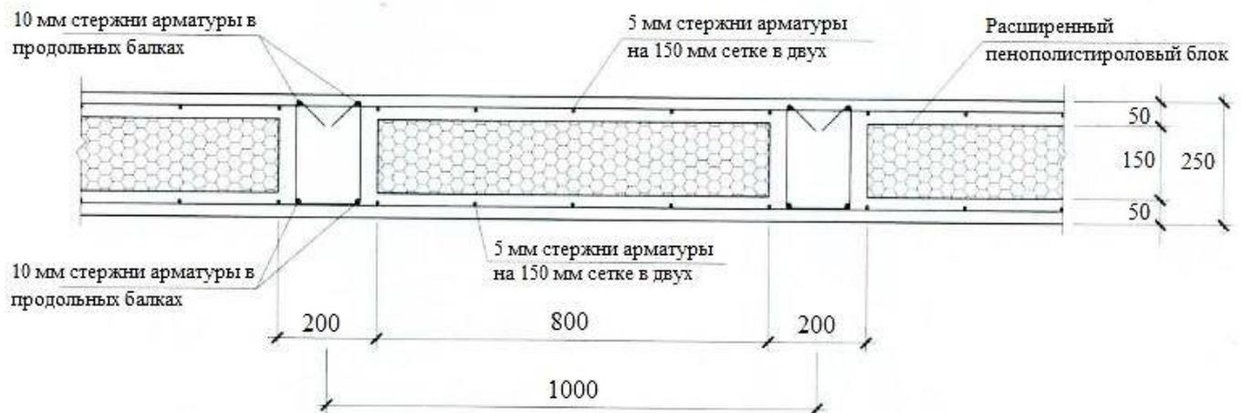
Рис. 1.4 Поперечний переріз залізобетонного перекриття хмарочоса
