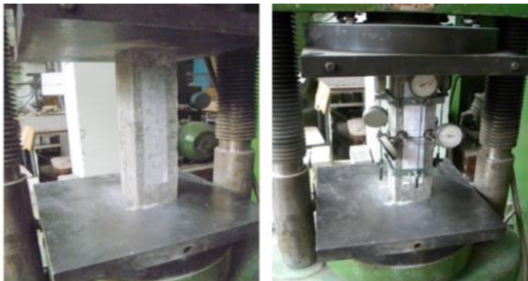
Рисунок 4.9 – Визначення призмової міцності (а) та модуля пружності (б) модифікованого високоміцного бетону
