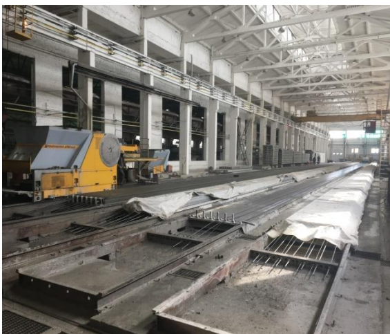
Рисунок 5.1 - Технологічна лінія “Nordimpianti” з виготовлення багатопустотних плит перекриття безперервним формуванням на ДП “Спецзалізобетон”
