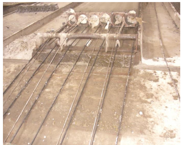
Рисунок 5.1 - Технологічна лінія “Nordimpianti” з виготовлення багатопустотних плит перекриття безперервним формуванням на ДП “Спецзалізобетон”
