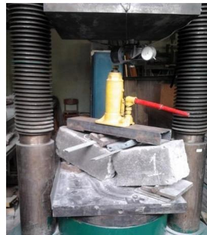
Рисунок 3.21 – Випробування зразків на розтяг при згині
