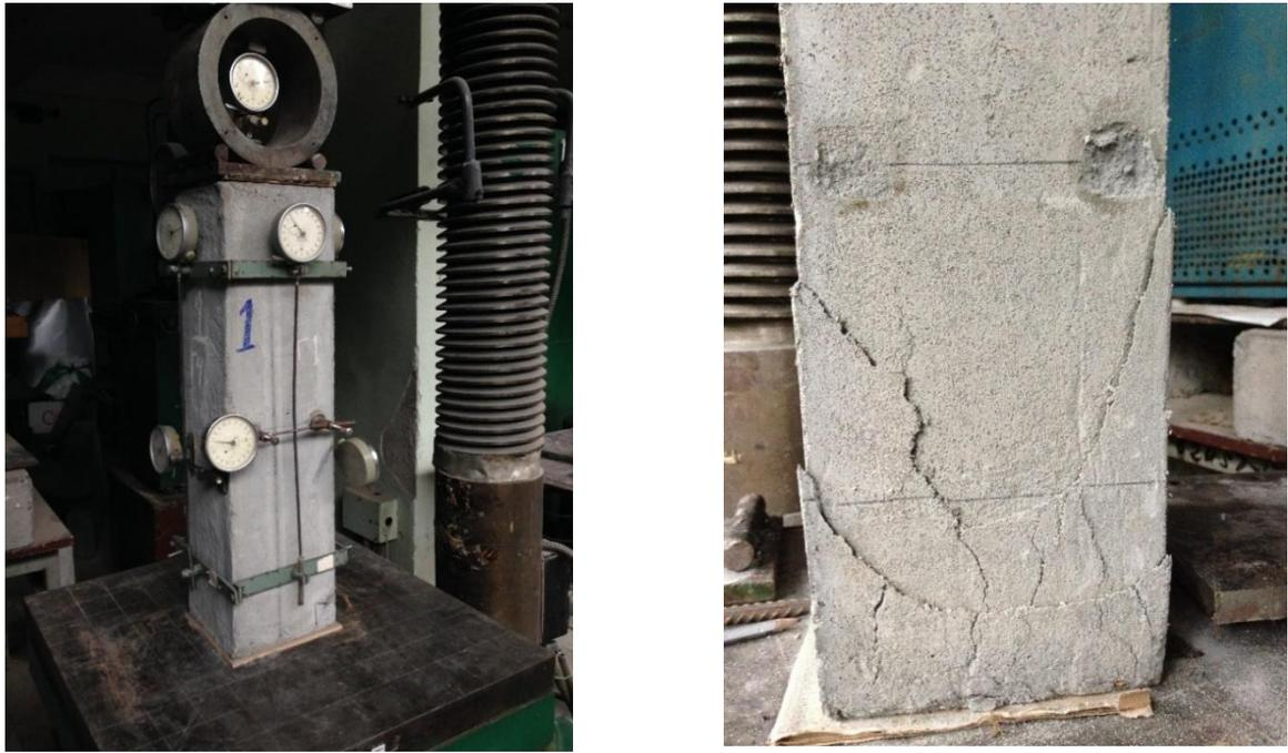
Рисунок 3.31 – Випробування зразків для визначення модуля пружності, призмової міцності та коефіцієнта Пуассона
