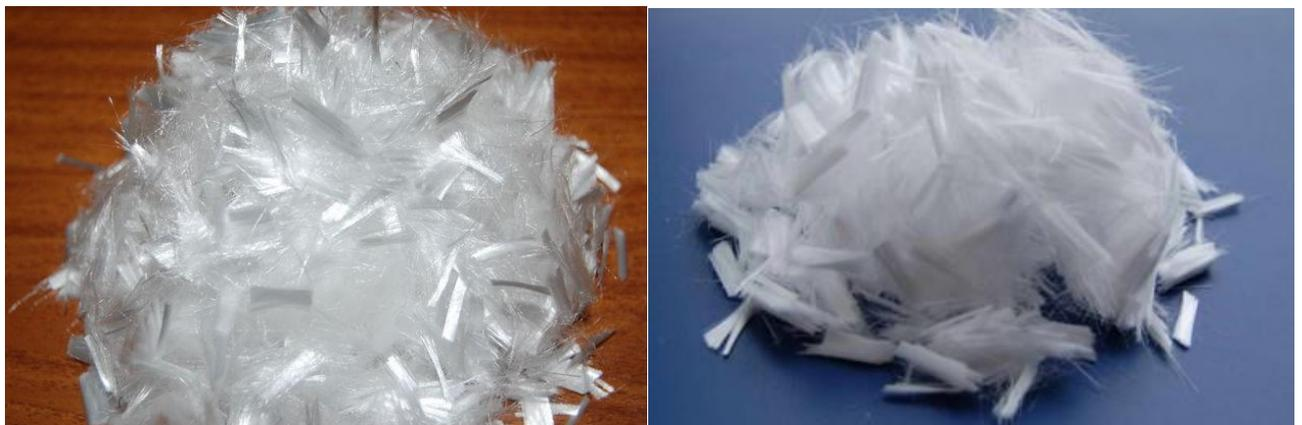
Рисунок 2.3 – Поліпропіленові волокна (фібра)
