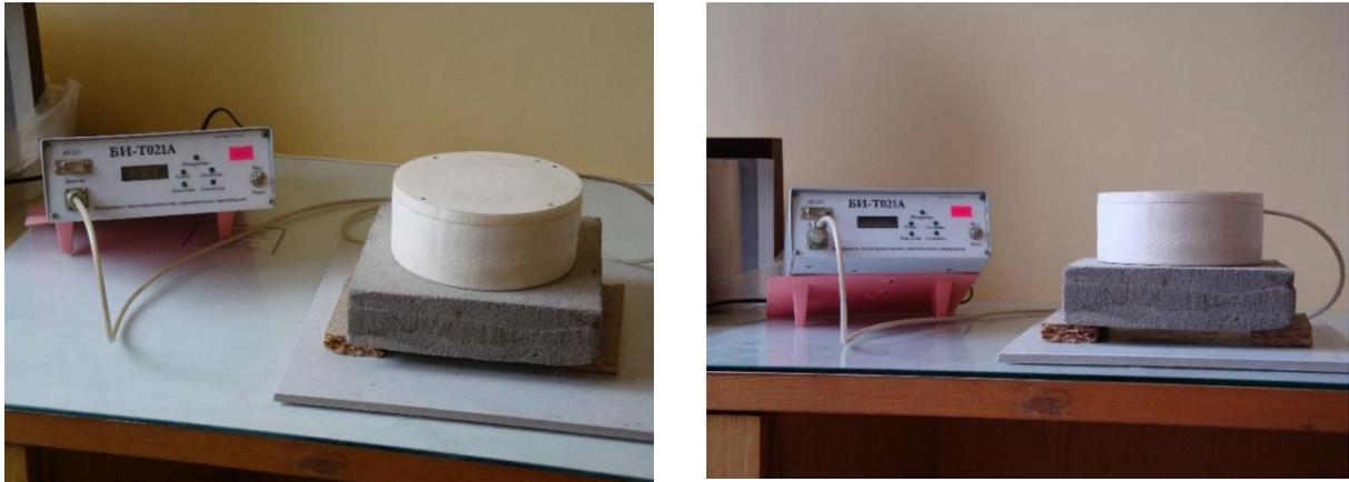
Рисунок 2.7 – Визначення теплопровідності дисперсноармованого пінобетону за допомогою приладу БИ-Т021А
