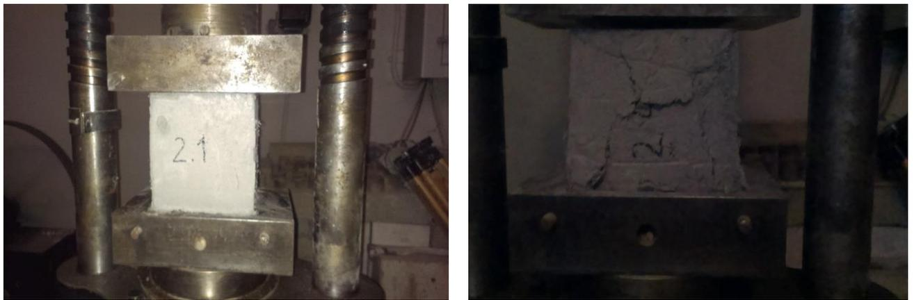
Рисунок 3.16 – Випробування зразків пінобетону на міцність при стиску
