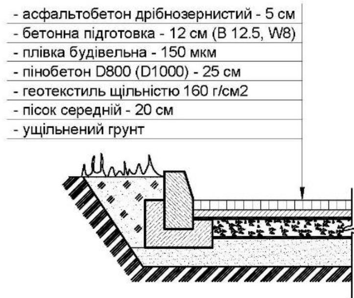
Рисунок 4.6 – Схема влаштування конструкції дорожнього одягу
