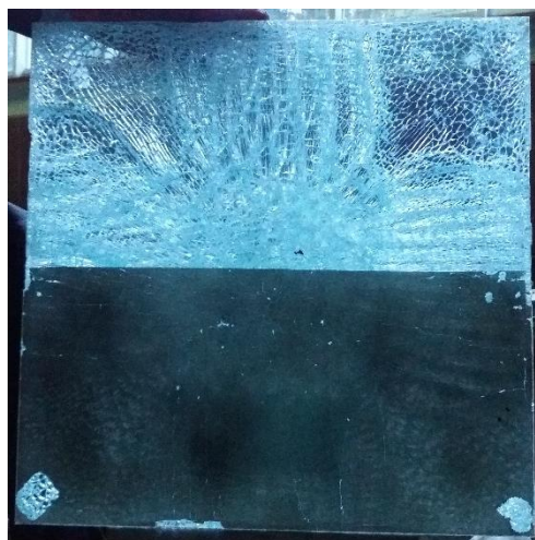
ПСБ-4.3, зруйновані всі шари (вигляд зверху)
