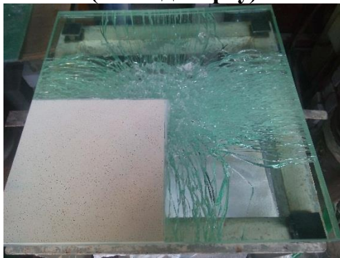
ПСБ-1.5, зруйновані всі шари (вигляд зверху)
