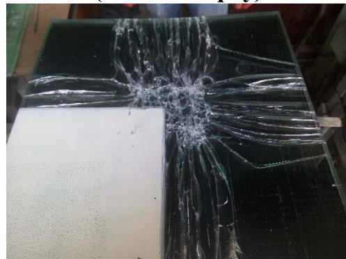
ПСБ-3.2, зруйновані всі шари (вигляд зверху)
