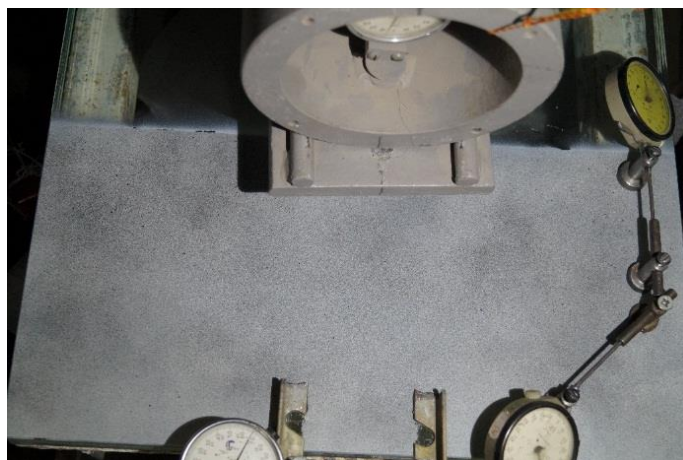
Рис. 2.11. Підготовка поверхні типового експериментального зразка для методу КІЗ при нанесенні стохастичної текстури аерозольною фарбою
