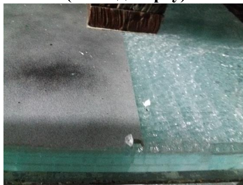
ПСБ-4.2, зруйновані всі шари (вигляд зверху)
