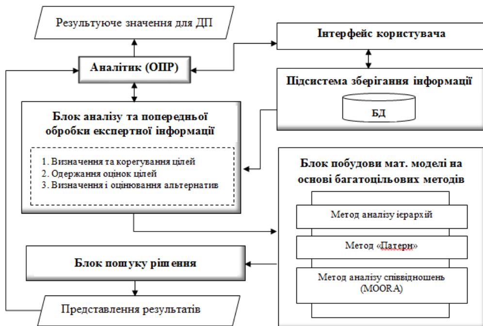
Рис.6.3 СППР для вирішення багатокритеріальних і багатоцільових задач
