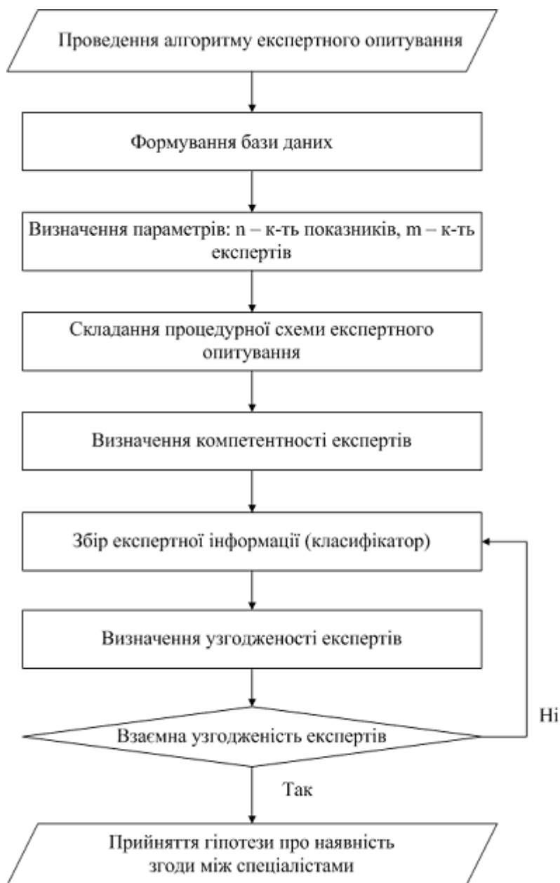
Рис.3.4 Узагальнений алгоритм експертного опитування з урахуванням компетентності експертів
