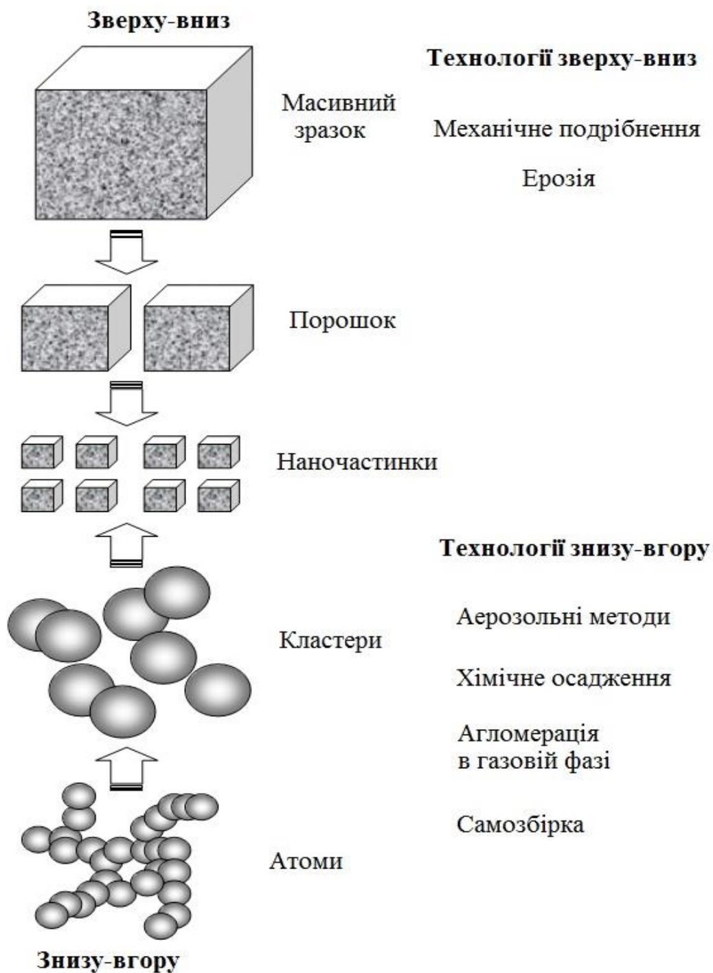
Рис. 1.1. Схематичне зображення формування наноструктур за технологією зверху – вниз та знизу – вгору [1].
