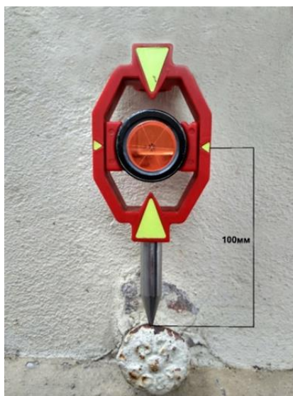
Рис.2.10 Міні-призма, установлена на стінному репері
