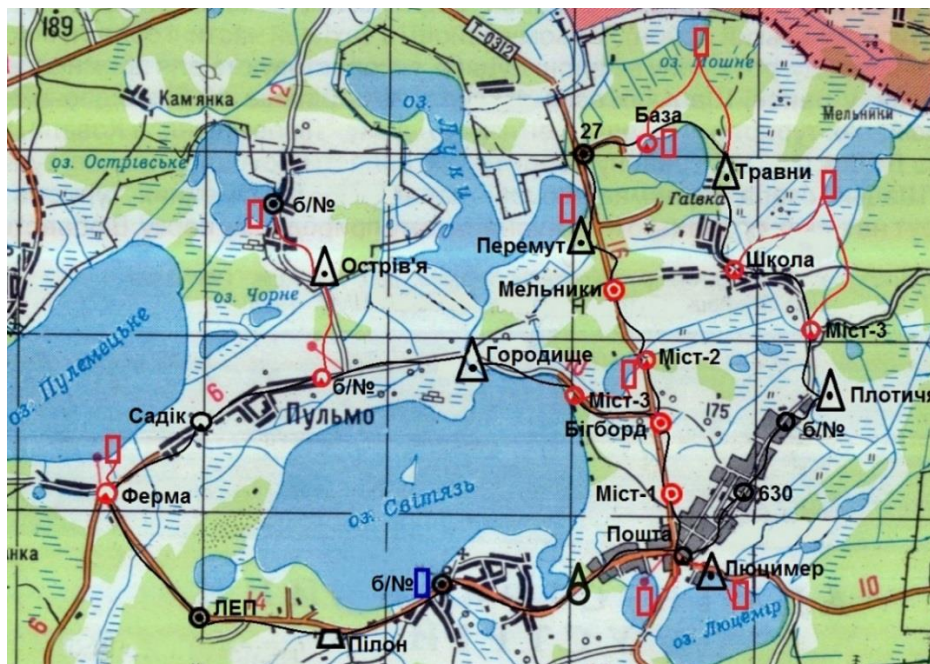
Рис. 3.2 Схема прив'язки водомірних постів до висотної геодезичної мережі на території ШНПП
