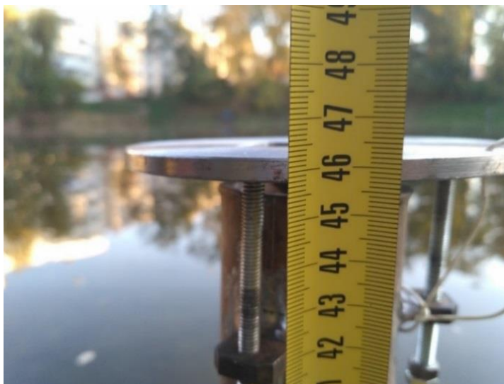
Рис. 3.56 Визначення відліку методом фотофіксації
