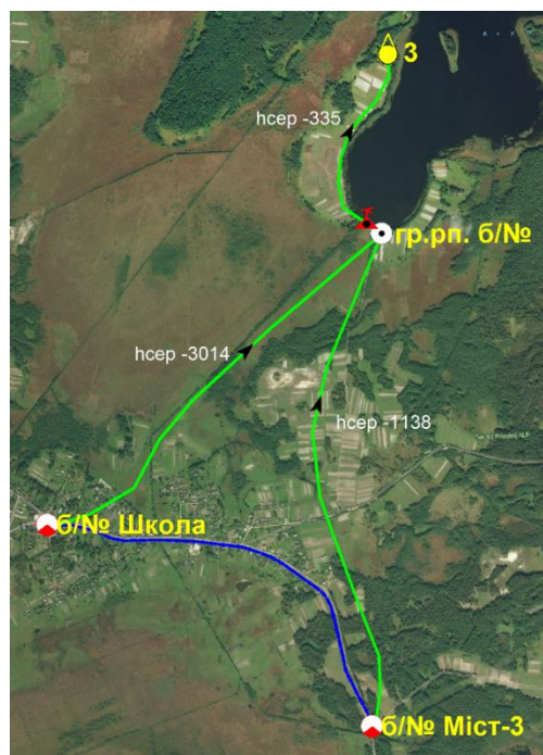
Рис. 11 Схема прив'язки свердловини №3 до реперів висотної геодезичної мережі
