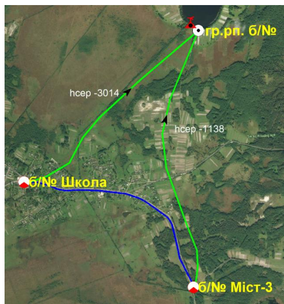
Рис. 6 Схема прив'язки водомірного посту до реперів висотної геодезичної мережі на озері а) Острів'янське б) Кримне
