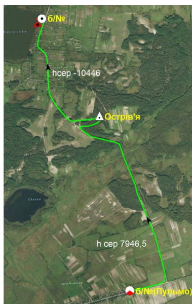
Рис. 6 Схема прив'язки водомірного посту до реперів висотної геодезичної мережі на озері а) Острів'янське б) Кримне
