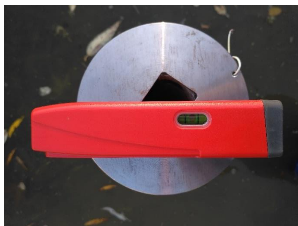
Рис. 3.54 Приведення підставки в горизонтальне положення
