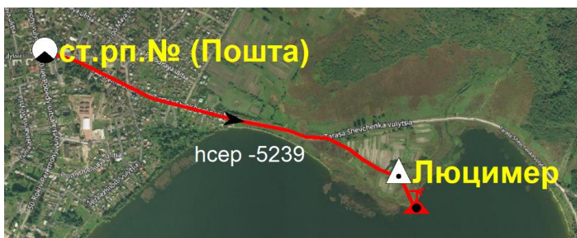
Рис. 8 Схема прив'язки водомірного посту на озері Люцимер до реперів висотної геодезичної мережі
