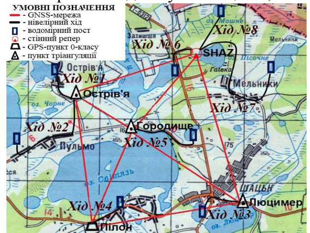
Рис. 4 Схема нівелірних ходів для дослідження контролю стабільності реперів водомірних постів
