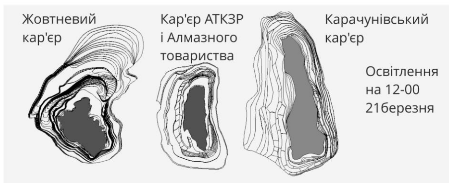
Рис.3.3. Схеми затінення бортів кар'єрів протягом дня (весняне рівнодення, 21 березня)
