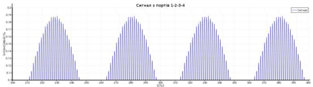
Рис. 2.12 Інтенсивність отриманого сигналу на виході чотирьохканального мультиплексора включеного як суматор по амплітуді 0,1 інтенсивності (моделювання).
