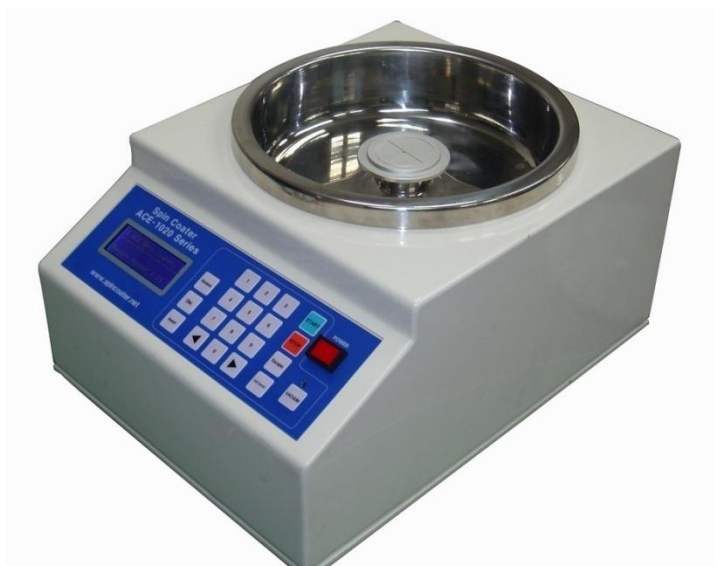
Рисунок 3.4. - Установка для процесу спін-покриття.
