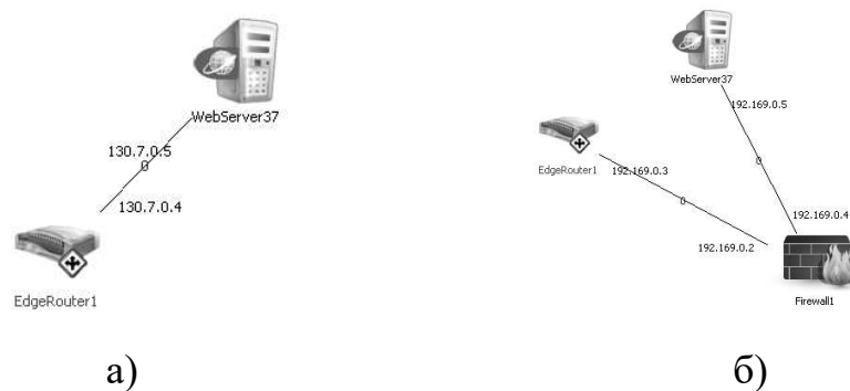
Рис. 4.10. Конфігурації ІТС: без засобів інформаційної безпеки (а) та із застосуванням мережного екрану (б)
