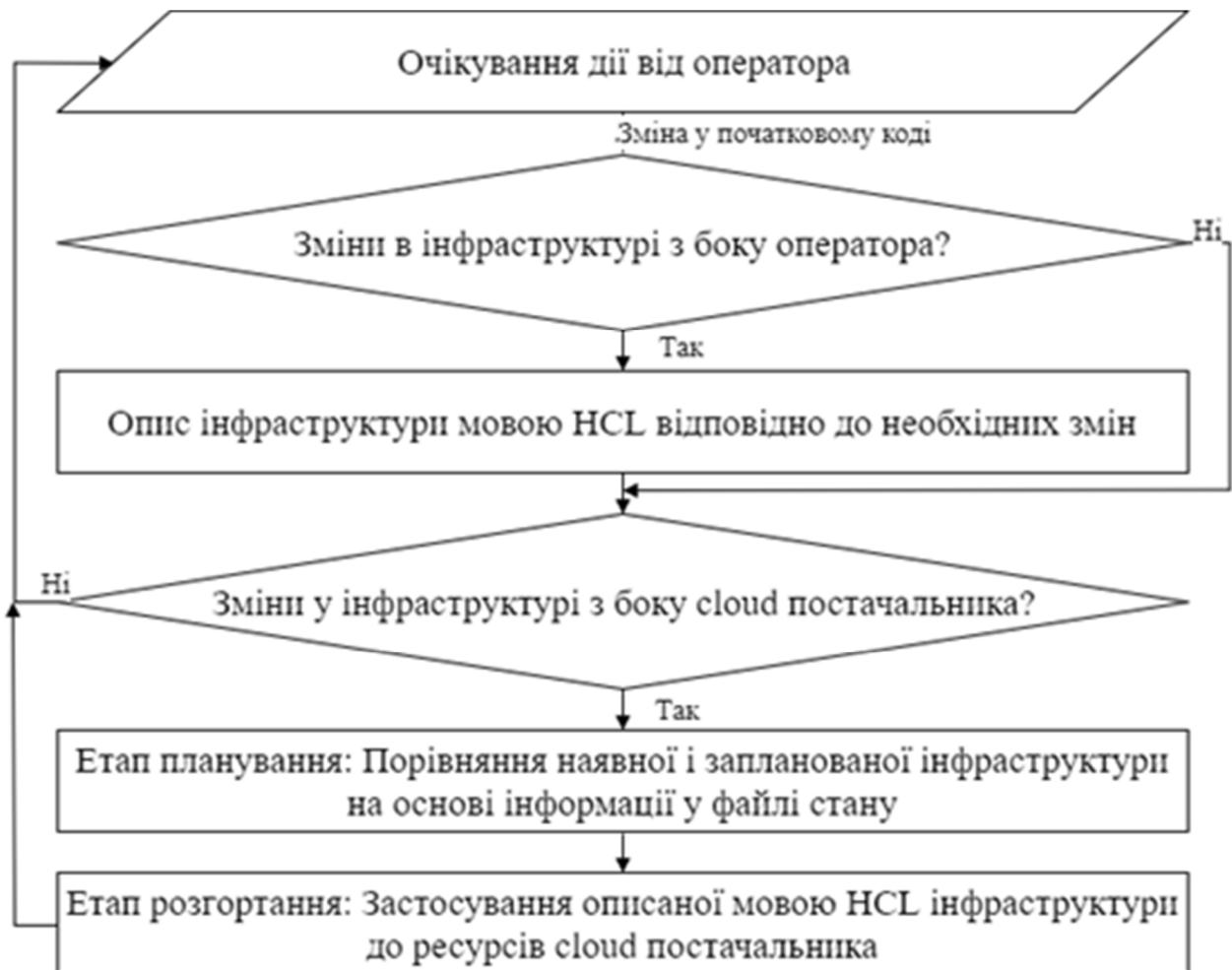
Рис. 4.22. Блок-схема створення хмарної інфраструктури з використанням Terraform, включаючи можливість відновлення після катастроф
