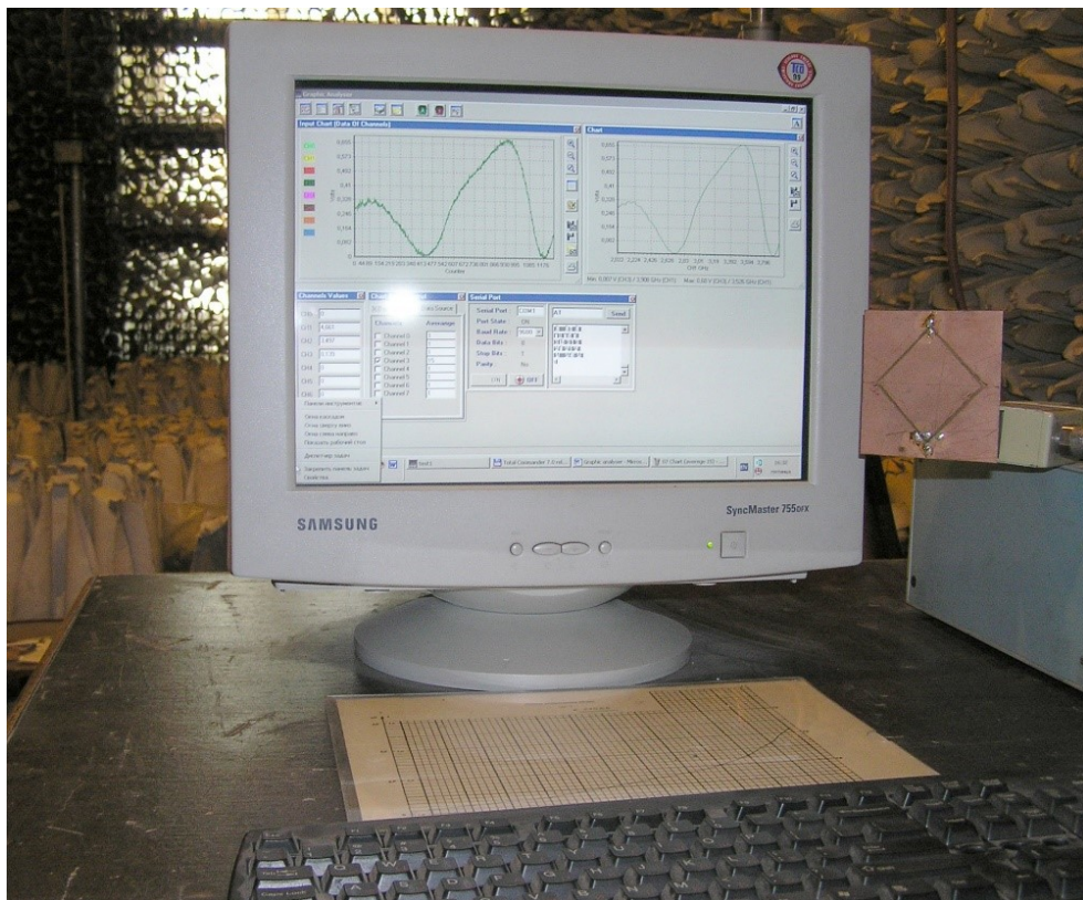
Рис. 4.8. Вимірювання характеристик щільного ромбічного випромінювача за допомогою програми Graphic analyzer
