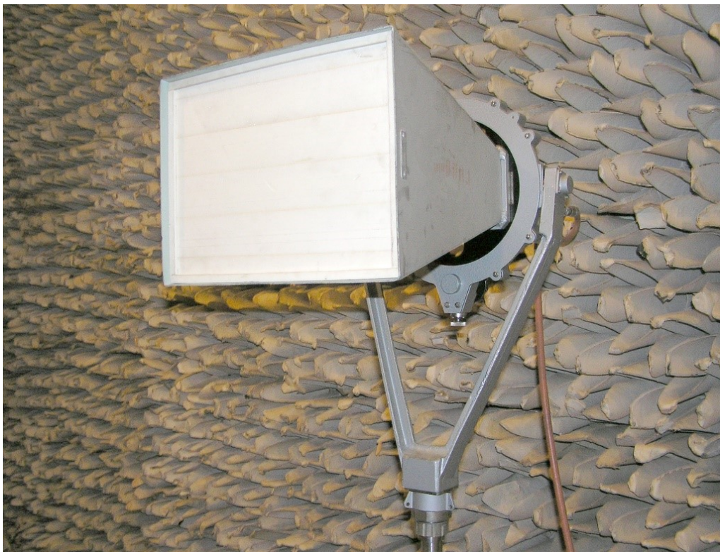
Рис. 4.4. Еталонна рупорна антена Пб-23А у безвідлунній камері
