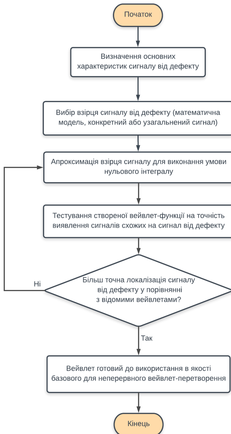
Рис. 3.13. Алгоритм створення вейвлет-функції для НВП, адаптованої до виявлення сигналів від дефектів при магнітодинамічній діагностиці залізничних рейок
