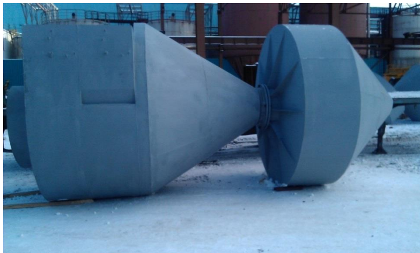
Рис. 5.25 Загальний вигляд відцентрового фільтра ЦФ2-6-20
