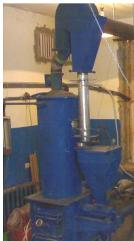
Рис 5.15 Фотографія експериментального стенду топки із шаровим спалюванням вугілля
