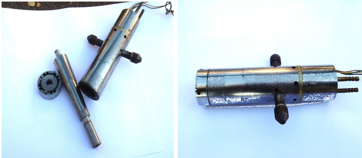
а) б) Рисунок 11 – Конічна опора в розібраному (а) та зібраному (б) вигляді
