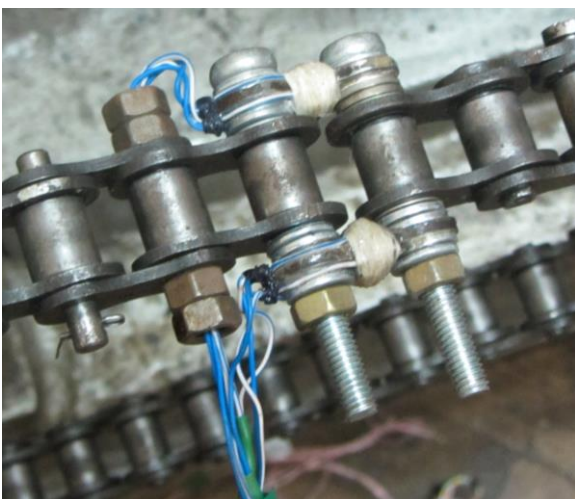
Рисунок 3.3 – Дослідна вимірювальна ланка, встановлена в металевому (ліворуч) та полімерному (праворуч) ланцюгових контурах ланцюгової передачі
