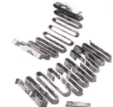
Рисунок 2 – Зруйнована змієподібна пружина
