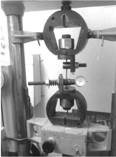
Рисунок 33 – Вимірювання зусилля опору екстракції каната на машині УММ-5
