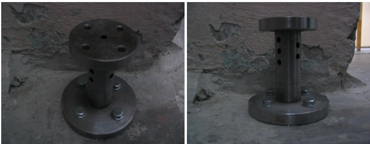
Рисунок 4.12 – Закріплення циліндра упорної (нижньої) частини установки
