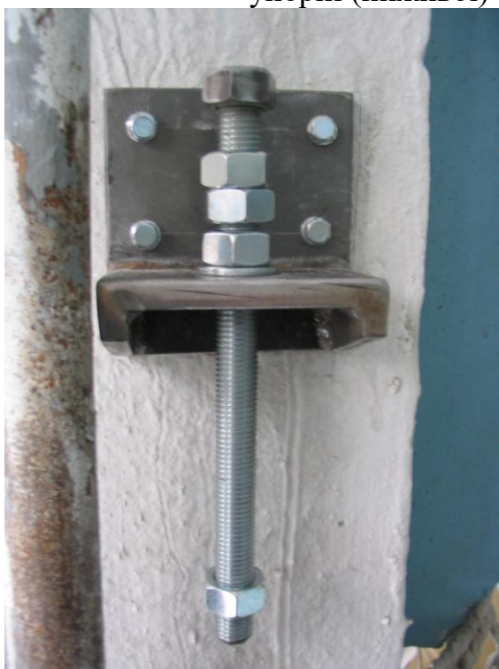
Рисунок 4.15 – Вигляд змонтованої натягувальної (верхньої) частини установки в зборі
