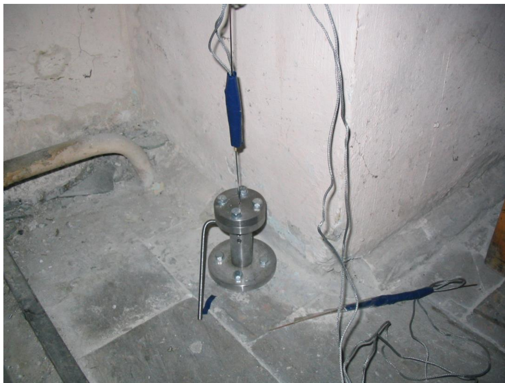
Рисунок 4.14 – Вигляд змонтованої на цементній підлозі упорні (нижньої) частини установки в зборі
