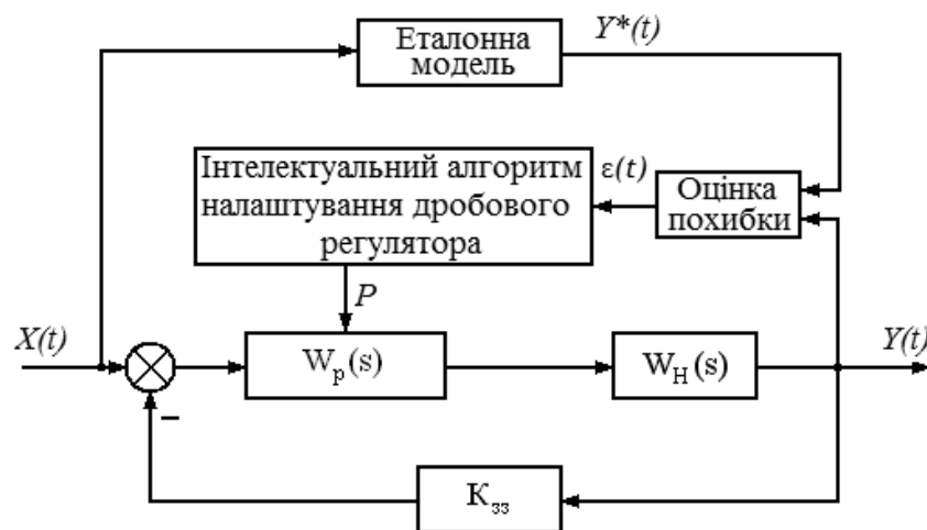
Рис. 3.11. Функціональна схема налагодження регулятора дробового порядку за використання еволюційних методів
