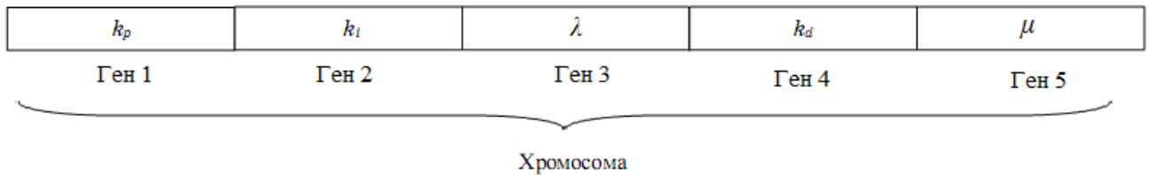
Рис. 3.14. Вигляд хромосоми при налаштуванні ПІД λμ -регулятора дробового порядку.
