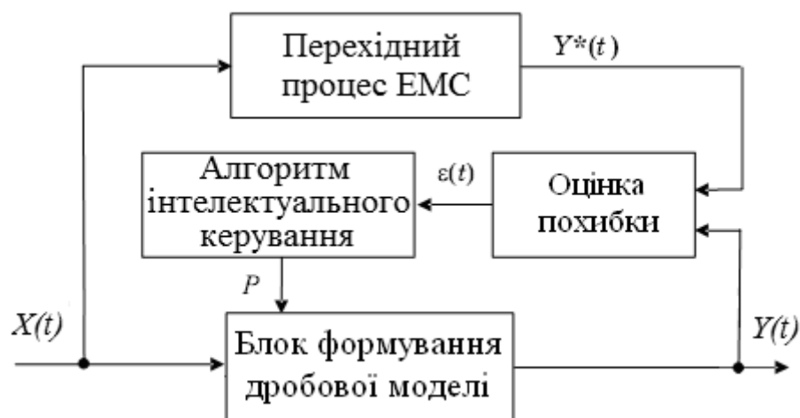
Рис. 2.1. Функціональна схема процедури апроксимації цілочисельної ПФ високого порядку дробовими моделями за використання інтелектуальних методів
