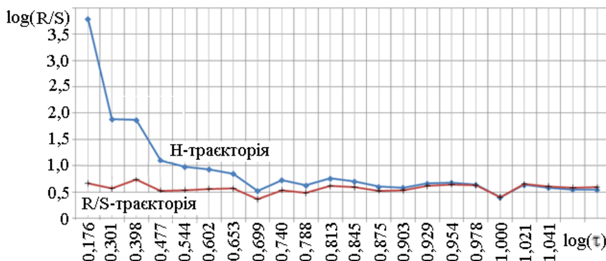
Рисунок 4.37 – R/S -траєкторія і H -траєкторія графіка електричного навантаження житлового будинку за 04.10.2017 р.
