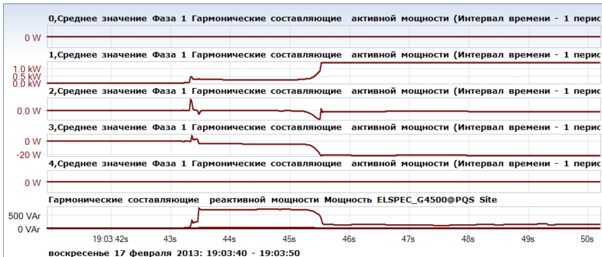
Рисунок В.12 – Середні значення гармонійних складових потужностей для мікрохвильової печі Samsung CE287GNR
