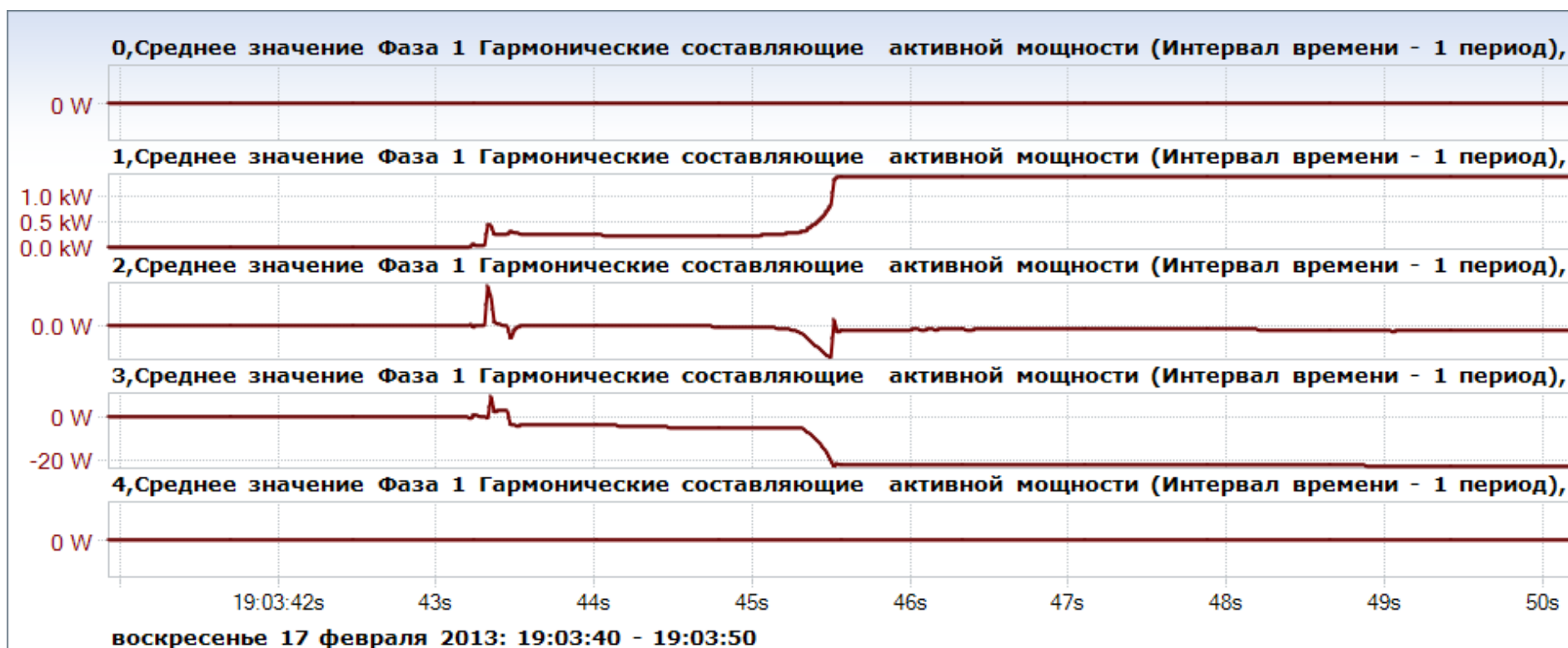
Рисунок В.11 – Середні значення гармонійних складових активної потужності для мікрохвильової печі Samsung CE287GNR
