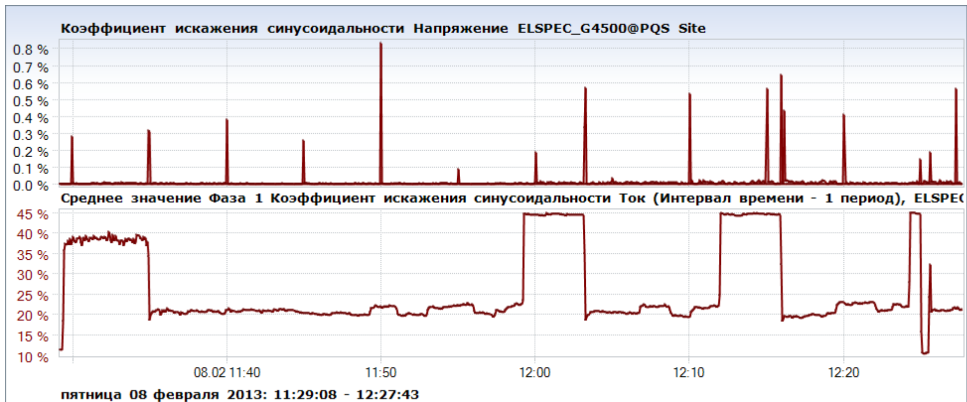
Рисунок В.21 – Середні значення коефіцієнтів спотворення синусоїдності напруги, струму кондиціонера Sensei ECO-і FTE-23MR
