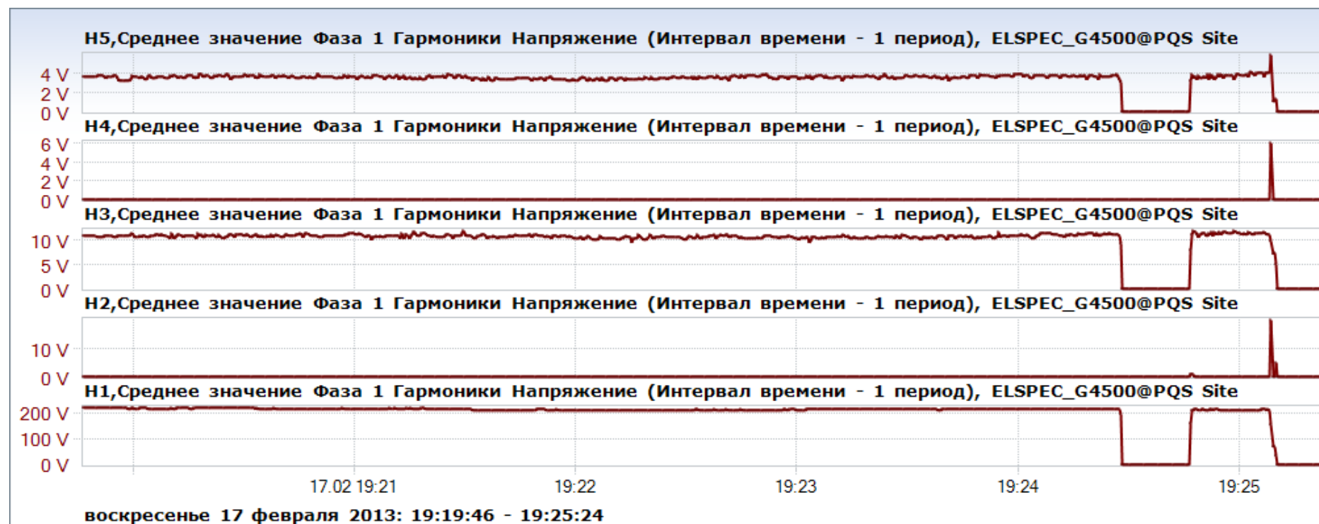
Рисунок В.16– Гармонійні складові напруги для тепловентилятора моделі S131
