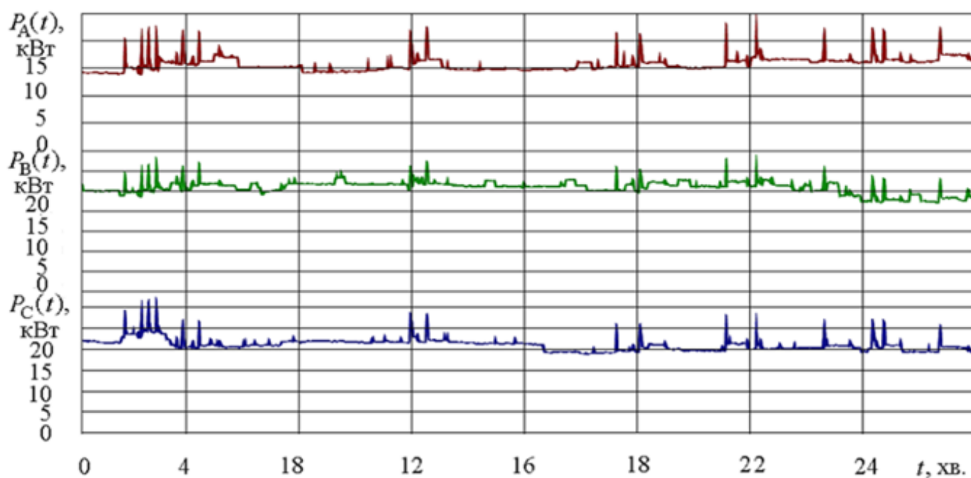
Рисунок 7.2 – Динаміка вечірнього електричного навантаження за фазами кабельного вводу 144-квартирного будинку за режимну добу
