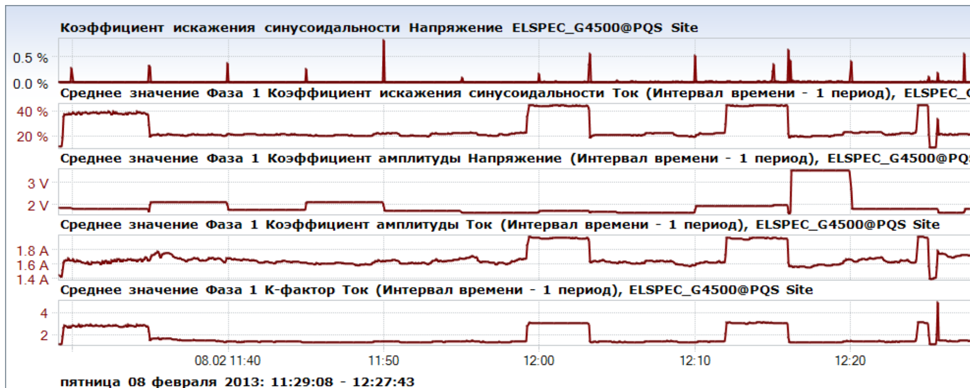
Рисунок В.22 – Середні значення коефіцієнтів спотворення, амплітуди, Х-фактора струму кондиціонера Sensei ECO-i FTE-23MR
