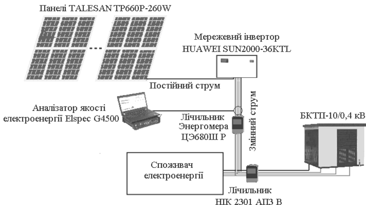
Рисунок 6.2– Основні елементи мережевої сонячної електростанції та схеми проведення дослідження
