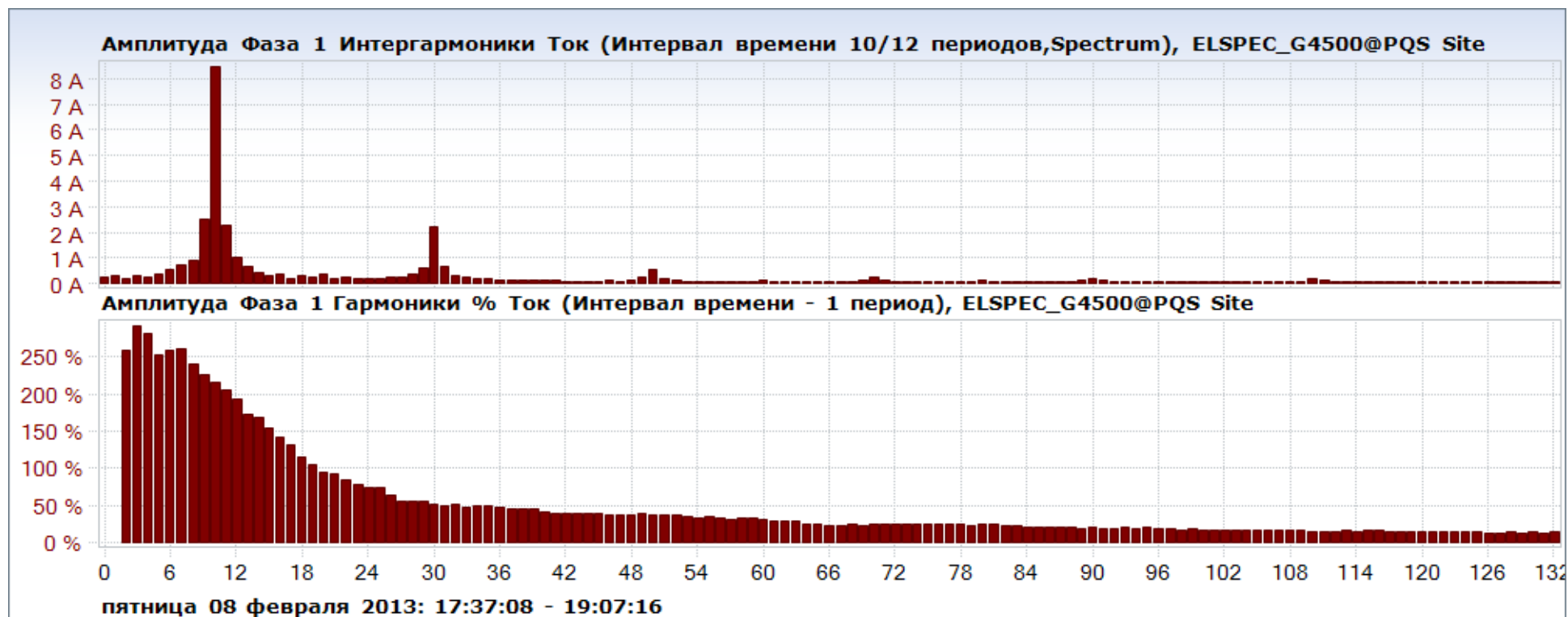
Рисунок В.28 – Амплітудний гармонійний спектр струму пральної машини Elektrolux
