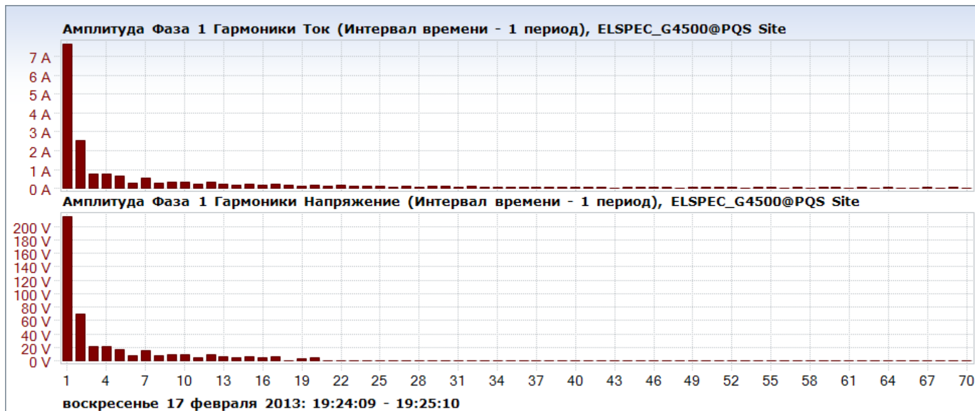
Рисунок В.18– Амплітудний гармонійний спектр струму, напруги тепловентилятора моделі S131
