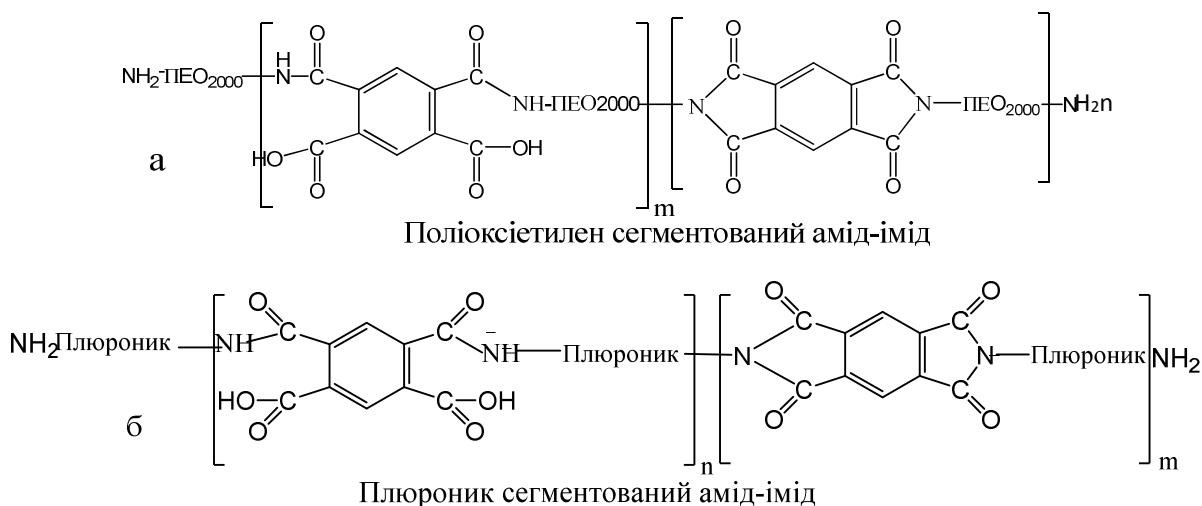
Рис. 1.23. Сегментовані кислі амід-іміди піромелітової кислоти з фрагментами: а – поліоксиетилену; б – плюроніку.
