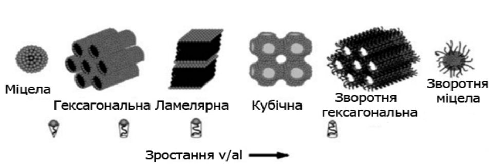
Рис. 1.24. Зміна форми колоїдних утворень, при збільшенні концентрації ПАР в залежності від будови молекули, яка визначає параметр упакування P = v/a_0 l
